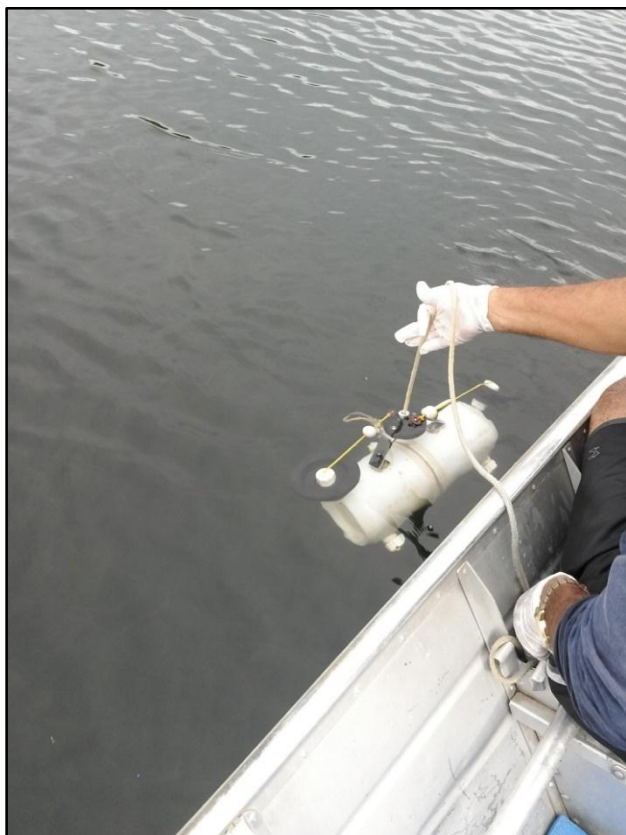
Figura 4. Coleta das amostras de água com auxílio de amostrador de profundidade do tipo van Dorn . Fotos: CARUSO JR., 2016.
