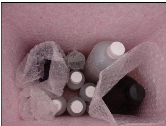
Figura 5. Preservação das amostras para envio a laboratório responsável pelas análises químicas. Fotos: CARUSO JR., 2016.
