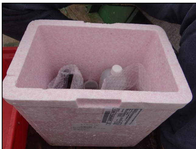
Figura 5. Preservação das amostras para envio a laboratório responsável pelas análises químicas. Fotos: CARUSO JR., 2016.
