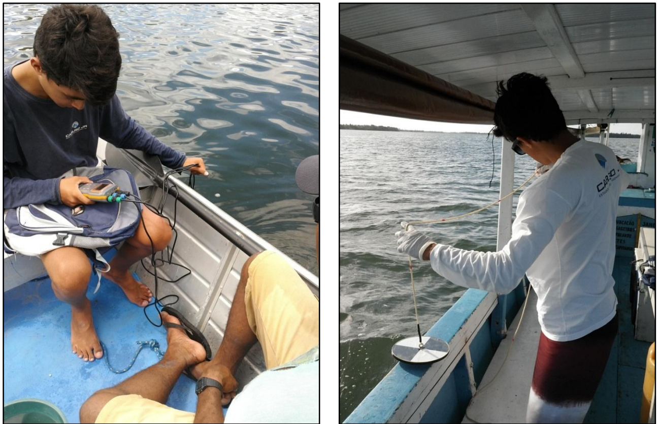
Figura 6. Medição in situ das variáveis de pH, condutividade, temperatura, oxigênio dissolvido, turbidez, salinidade e transparência com o auxílio de equipamento mutiparâmetro e disco de secchi. Fotos: CARUSO JR., 2016.
