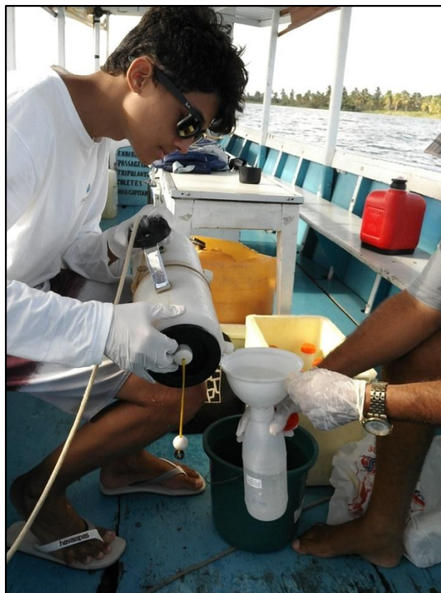
Figura 4. Coleta das amostras de água com auxílio de amostrador de profundidade do tipo van Dorn . Fotos: CARUSO JR., 2016.
