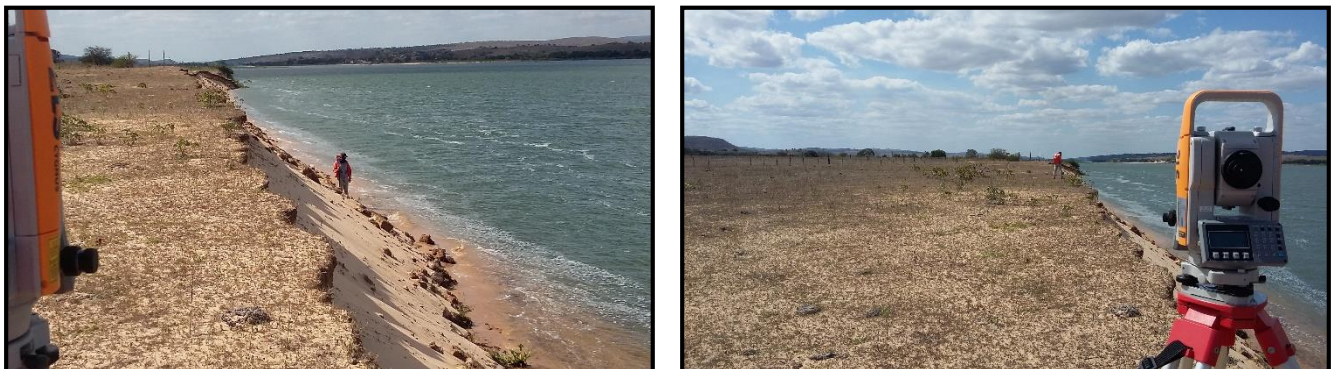
Figura 2.15. Vistas da estação EM B-08, com vegetação escassa e evidência de erosão.
