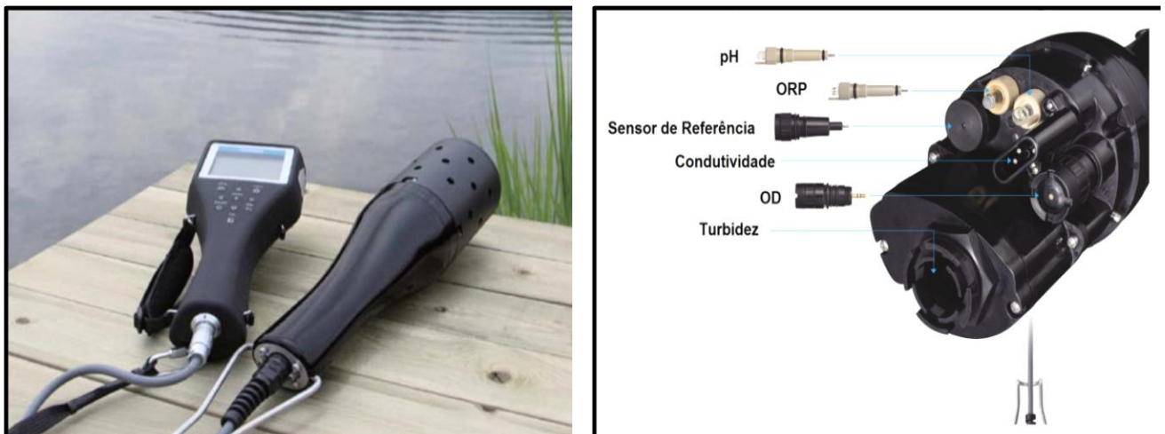
Figura 4. Equipamento utilizado nas medições de temperatura, condutividade e salinidade da água no baixo estuário do Rio São Francisco – sonda multiparâmetro Horiba, série U-50. No painel direito são apresentados os detalhes dos sensores.
