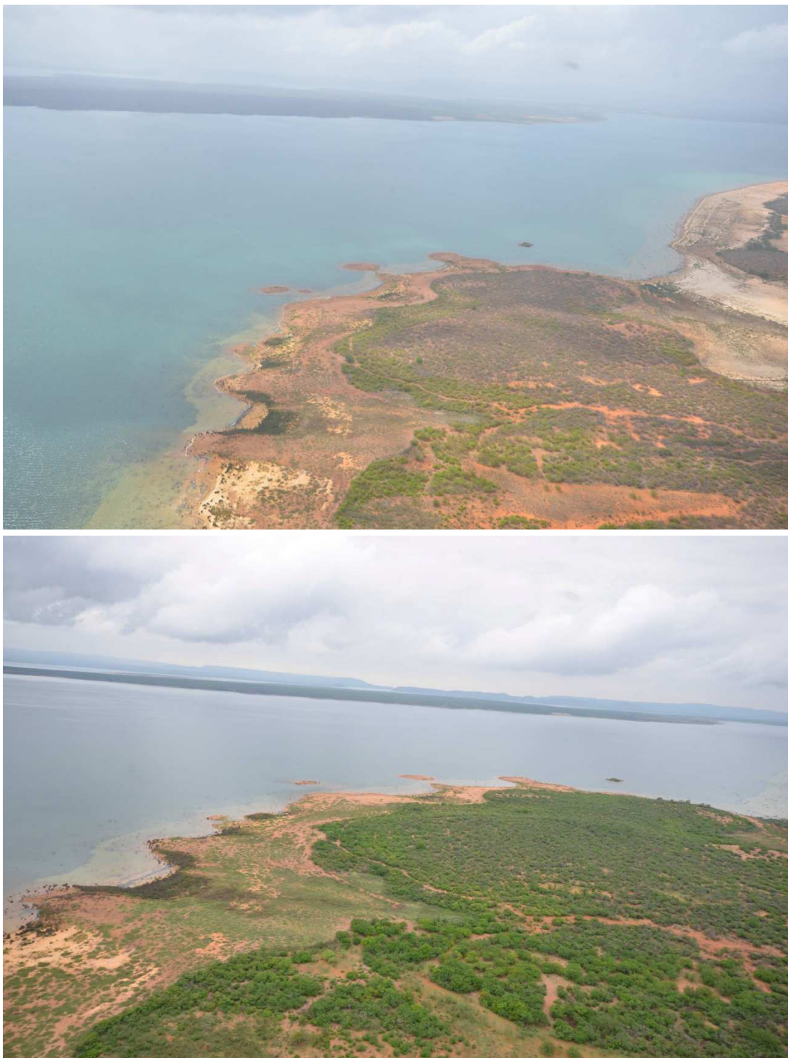
Figura 9 – Margem na porção intermediária do Reservatório de Itaparica (08°59'24.56"S; 038°22'48.55"O) nas vazões de 850 m 3 /s (acima) e 800 m 3 /s (abaixo).
