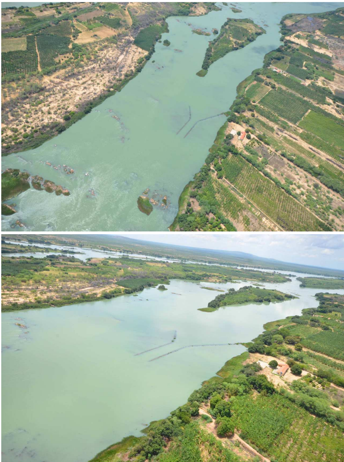
Figura 5 – Trecho anostomosado e afloramentos rochosos no leito do Submédio São Francisco (08°47'4.36"S; 039°46'9.45"O) nas vazões de 850 m 3 /s (acima) e 800 m 3 /s (abaixo).
