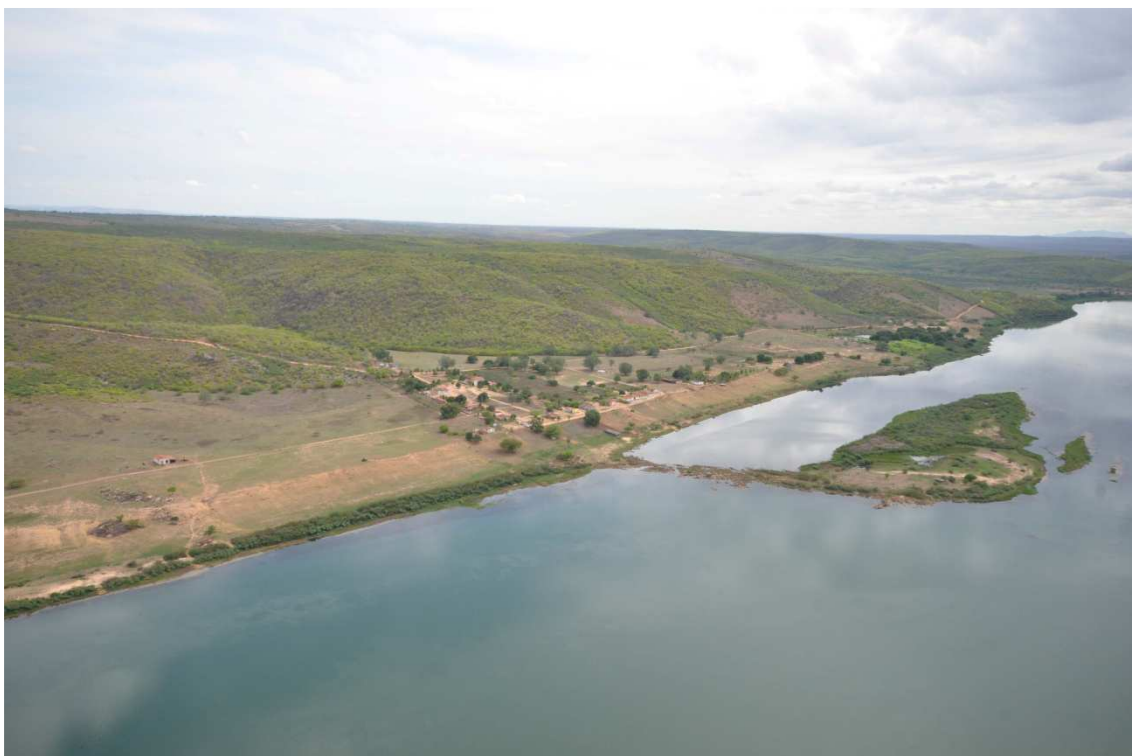
Figura 13 – Formação de conexão de ilha à margem no Baixo São Francisco (09°46'47.96"S; 037°22'38.33"O) nas vazões de 850 m 3 /s (acima) e 800 m 3 /s (abaixo).
