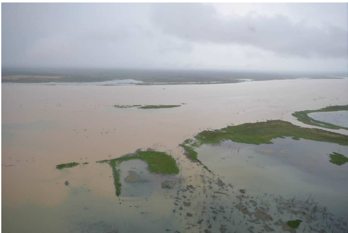
Figura 11 – Área lateral alagável na porção superior do Reservatório de Itaparica (08°46'3.25"S; 038°51'54.99"O) nas vazões de 850 m 3 /s (acima) e 800 m 3 /s (abaixo).
