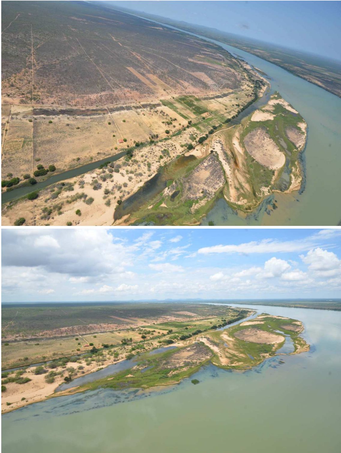
Figura 2 – Canais laterais e acúmulo de sedimentos na parte interna de curva do Submédio São Francisco (09° 3'21.18"S; 040°13'59.46"O) nas vazões de 850 m 3 /s (acima) e 800 m 3 /s (abaixo).
