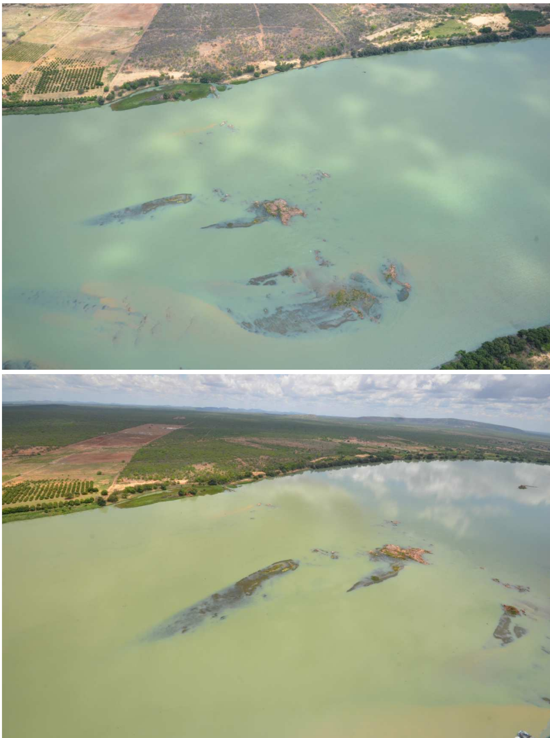
Figura 3 – Afloramentos rochosos no leito do Submédio São Francisco (08°53'50.41"S; 039°53'9.19"O) nas vazões de 850 m 3 /s (acima) e 800 m 3 /s (abaixo).
