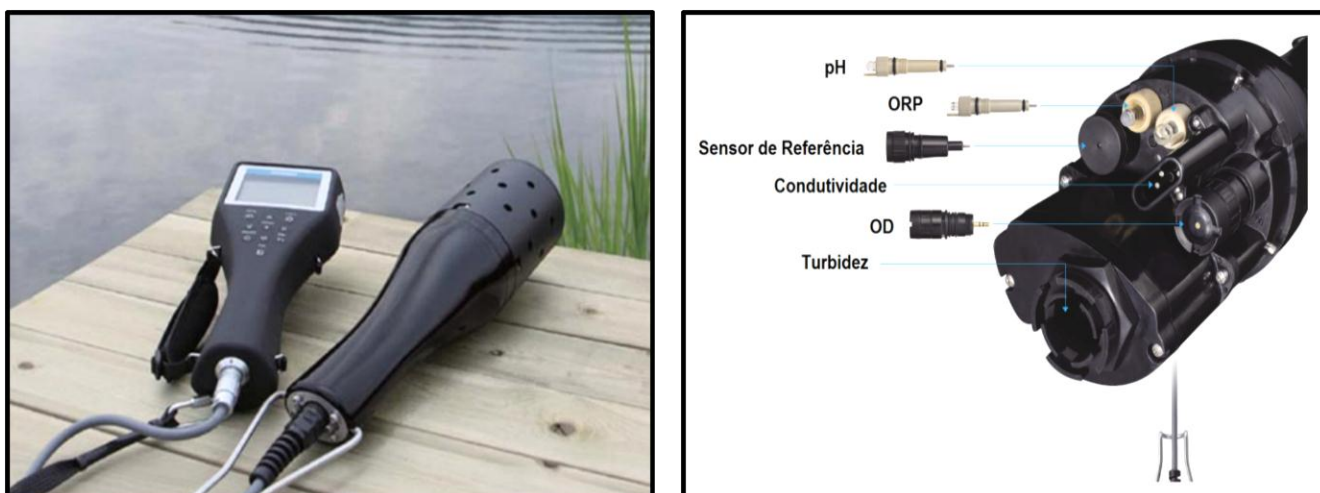
Figura 4. Equipamento utilizado nas medições de temperatura, condutividade e salinidade da água no baixo estuário do Rio São Francisco – sonda multiparâmetro Horiba, série U-50. No painel direito os detalhes dos sensores.
