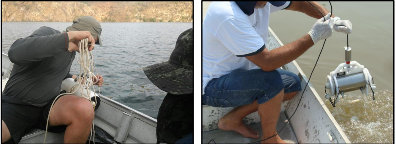
Figura 1.3. Coleta das amostras de água com auxílio de amostrador de profundidade do tipo van Dorn . Fotos: CARUSO JR., 2016.
