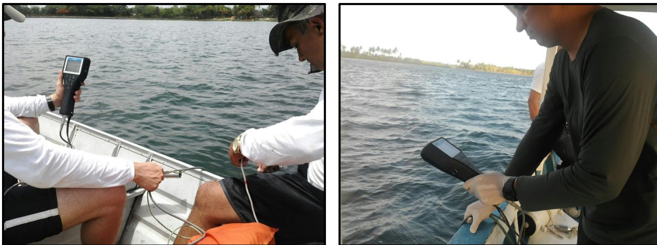
Figura 5. Medição in situ das variáveis de pH, condutividade, temperatura, oxigênio dissolvido, turbidez, salinidade e transparência com o auxílio de equipamento mutiparâmetro. Fotos: CARUSO JR., 2016.
