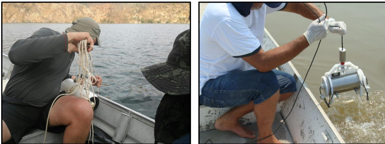
Figura 3. Coleta das amostras de água com auxílio de amostrador de profundidade do tipo van Dorn . Fotos: CARUSO JR., 2016.
