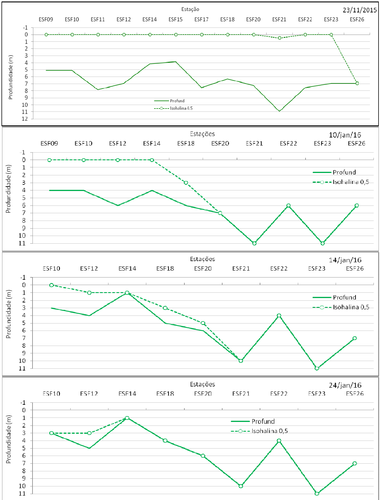
Figura 16 - Comportamento longitudinal da cunha salina de preamar na foz do Rio São Francisco de novembro/2015 a janeiro/2016 (vazão média diária de 1.104 m 3 /s para as datas, medida na estação fluviométrica de Propriá/SE).
