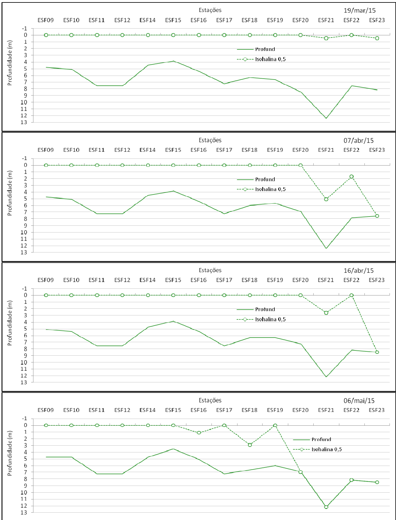
Figura 10 - Comportamento longitudinal da cunha salina de preamar na foz do Rio São Francisco de março a maio/2015 (vazão média diária de 1.237 m 3 /s para as datas, medida na estação fluviométrica de Propriá/SE).
