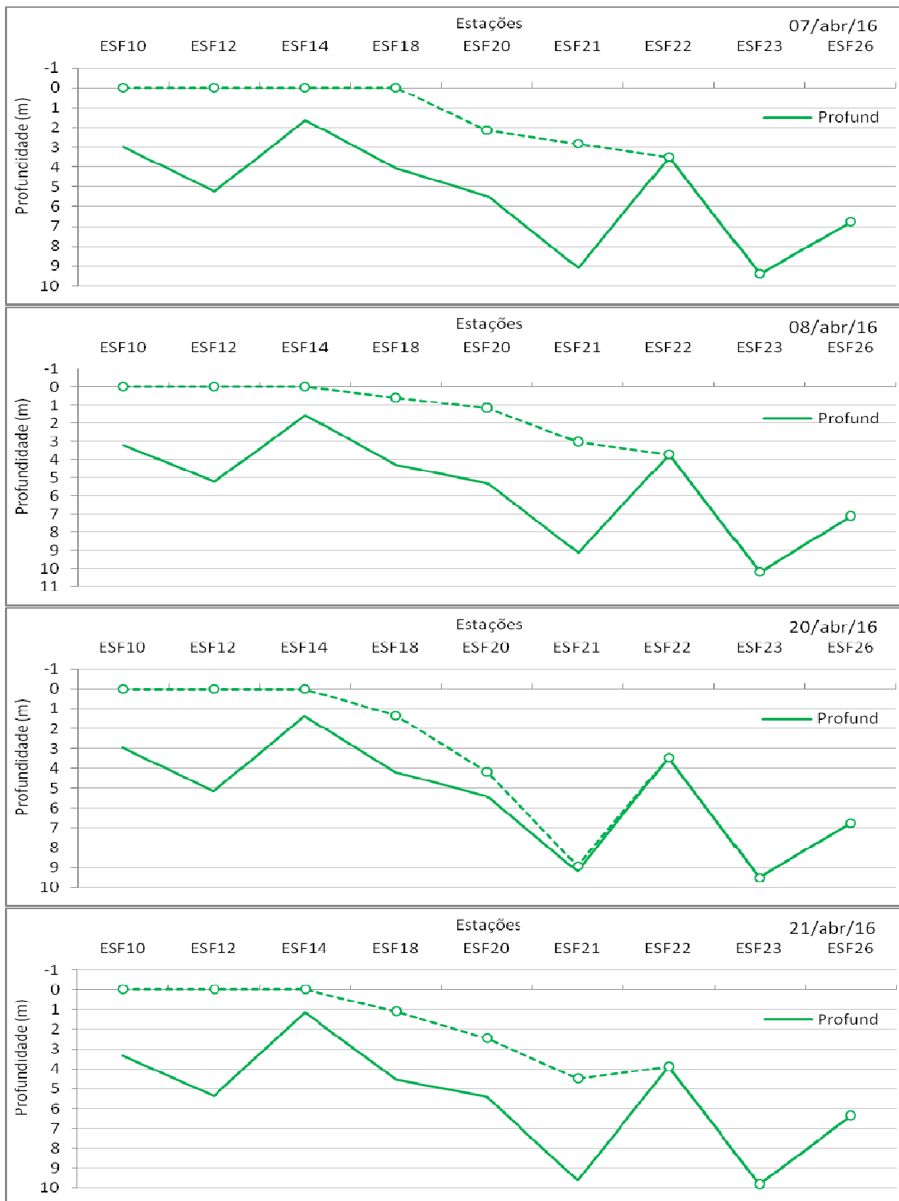
Figura 19 – Comportamento longitudinal da cunha salina de preamar na foz do Rio São Francisco de abril/2016 (vazão média diária abaixo de 833 m 3 /s para as datas, medida na estação fluviométrica de Propriá/SE).
