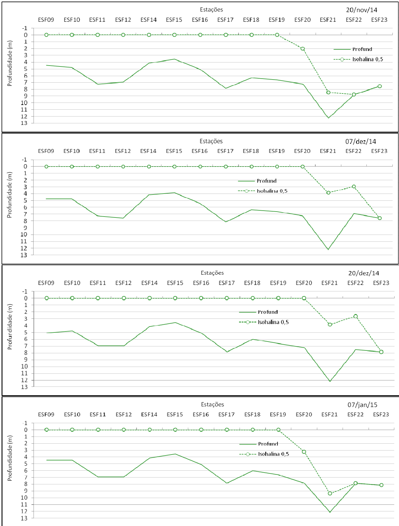
Figura 8 – Comportamento longitudinal da cunha salina de preamar na foz do Rio São Francisco de novembro/2014 a janeiro/2015 (vazão média diária de 1.149 m 3 /s para as datas, medida na estação fluviométrica de Propriá/SE).
