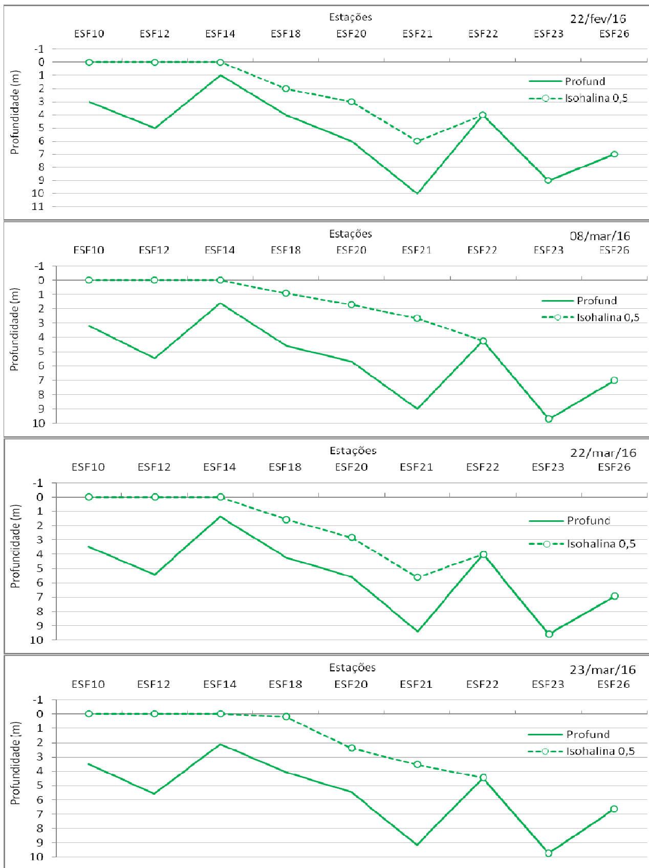
Figura 18 - Comportamento longitudinal da cunha salina de preamar na foz do Rio São Francisco de fevereiro a março/2016 (vazão média diária de 897 m 3 /s para as datas, medida na estação fluviométrica de Propriá/SE).
