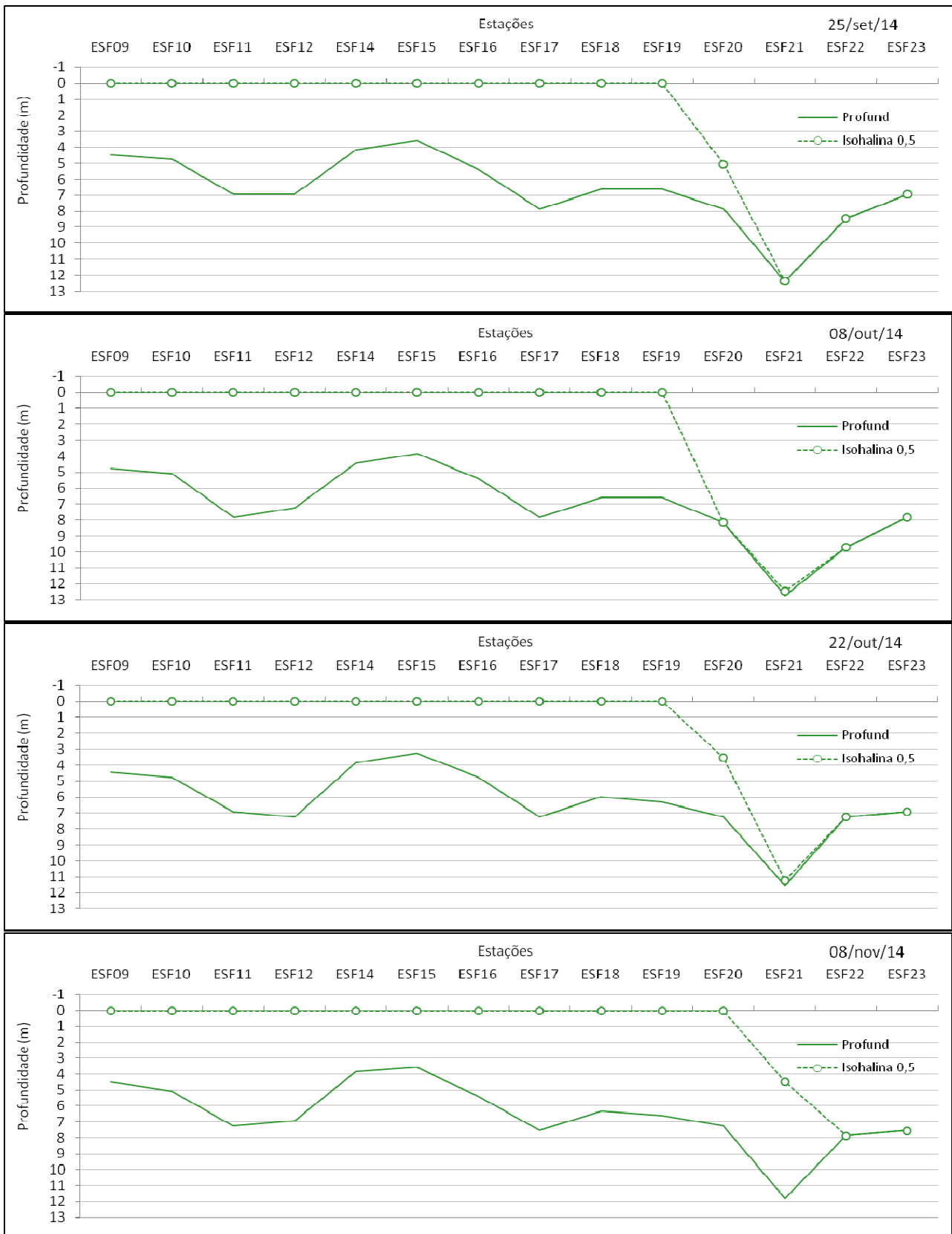
Figura 7 – Comportamento longitudinal da cunha salina de preamar na foz do Rio São Francisco de setembro a novembro/2014 (vazão média diária de 1.186 m 3 /s para as datas, medida na estação fluviométrica de Propriá/SE).
