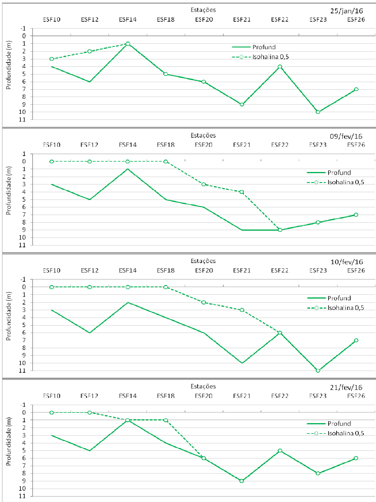
Figura 17 - Comportamento longitudinal da cunha salina de preamar na foz do Rio São Francisco de janeiro a fevereiro/2016 (vazão média diária de 930 m 3 /s para as datas, medida na estação fluviométrica de Propriá/SE).
