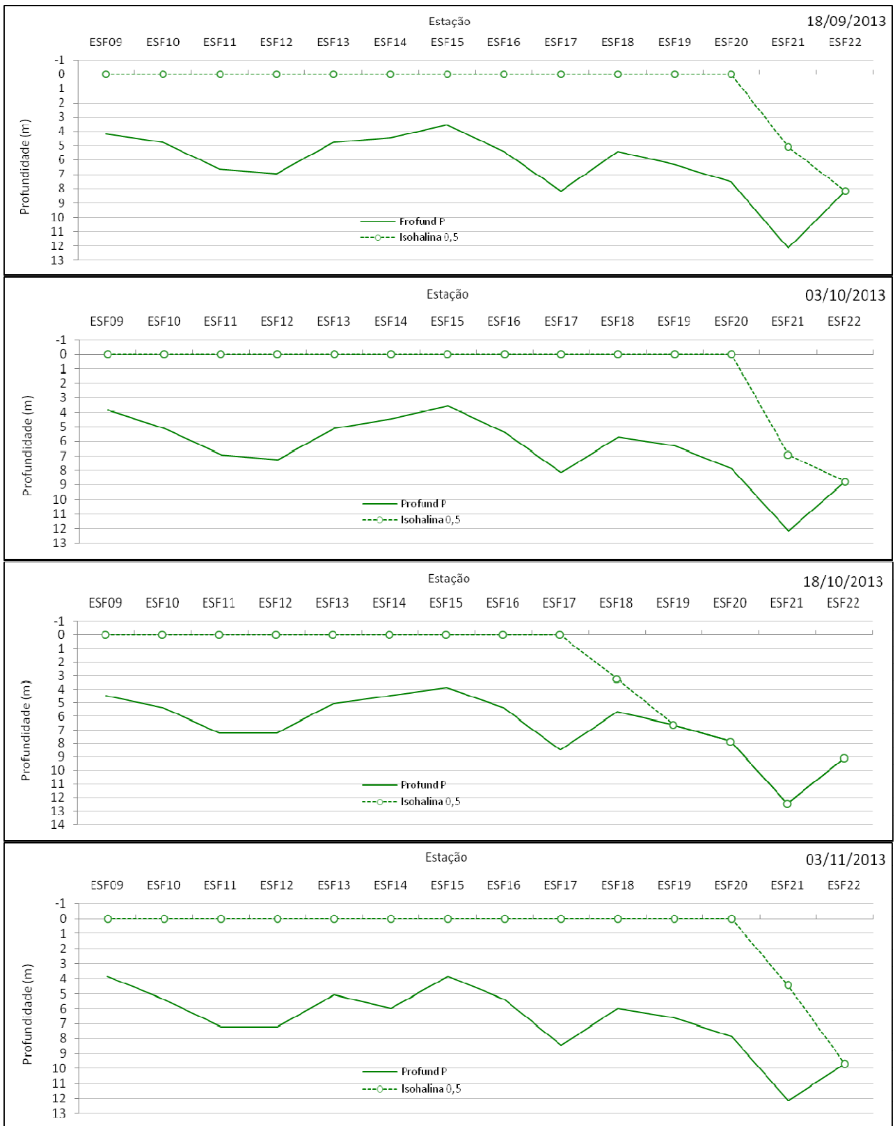
Figura 4 – Comportamento longitudinal da cunha salina de preamar na foz do Rio São Francisco de setembro a novembro/2013 (vazão média diária de 1.336 m 3 /s para as datas, medida na estação fluviométrica de Propriá/SE).
