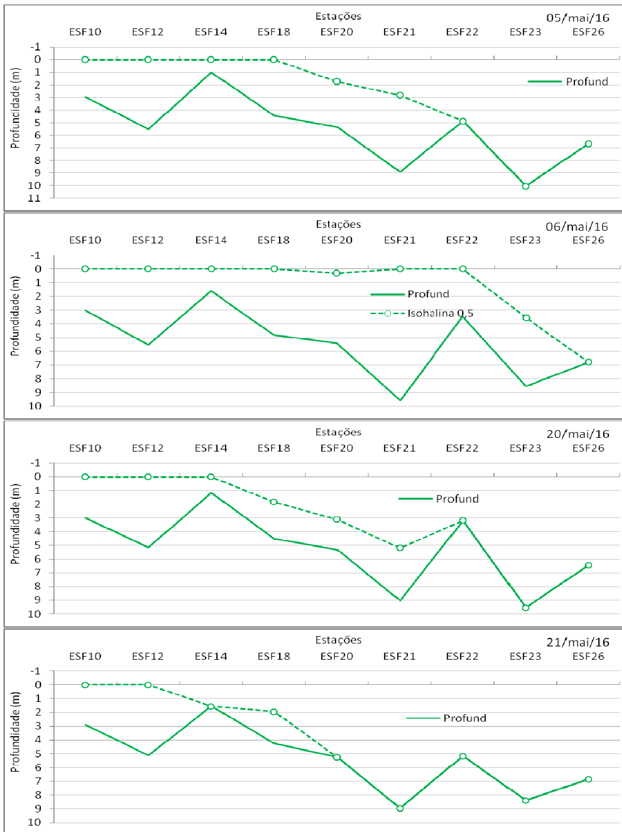
Figura 20 - Comportamento longitudinal da cunha salina de preamar na foz do Rio São Francisco de maio/2016 (vazão média diária abaixo de 845 m 3 /s para as datas, medida na estação fluviométrica de Propriá/SE).
