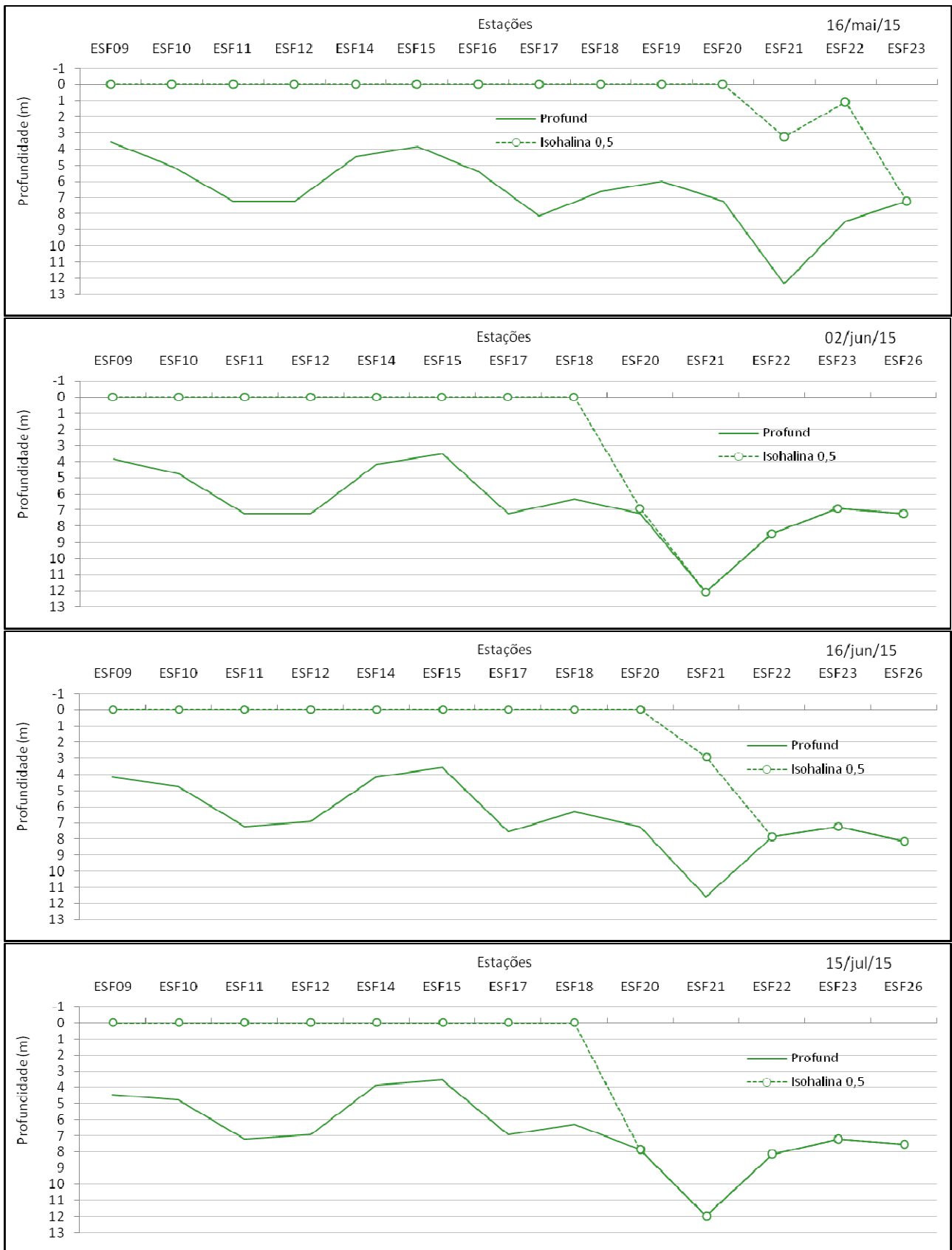
Figura 11 - Comportamento longitudinal da cunha salina de preamar na foz do Rio São Francisco de maio a julho/2015 (vazão média diária de 1.026 m 3 /s para as datas, medida na estação fluviométrica de Propriá/SE).
