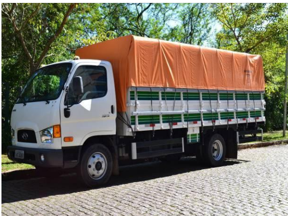
Foto 73 - Detalhe do veículo caminhão adquirido pela AGROSIG com carroceria de madeira modelo graneleiro altura 0,90 metros (0,45 + 0,45) com arcos de aço altura interna de 1,70 metros desmontável, fabricada especialmente para execução dos serviços realizados no viveiro da UHE Xingó.
