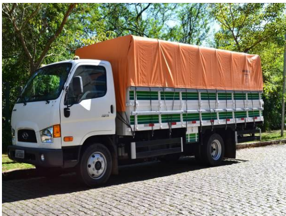
Foto 49 - Caminhão marca Hyundai modelo HD 78 adquirido pela AGROSIG com carroceria de madeira modelo graneleiro altura 0,90 metros (0,45 + 0,45) com arcos de aço altura interna de 1,70 metros desmontável, disponível para execução dos serviços realizados no viveiro da UHE Xingó.
