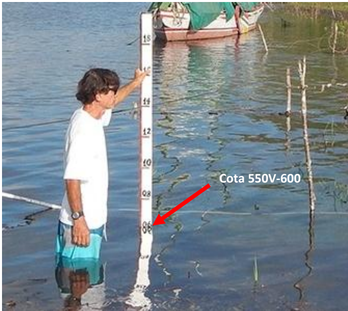
Figura 4 - Aproximação da régua graduada indicando a marca de 600 mm acima do "zero", relativo à cota de espelho d'água da vazão 550 m 3 /s.
