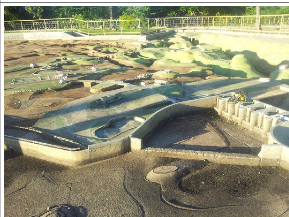
Foto 38: Modelo reduzido do Complexo de Paulo Afonso. Coordenadas: 9°23'29.00"S e 38°12'51.54"W.
