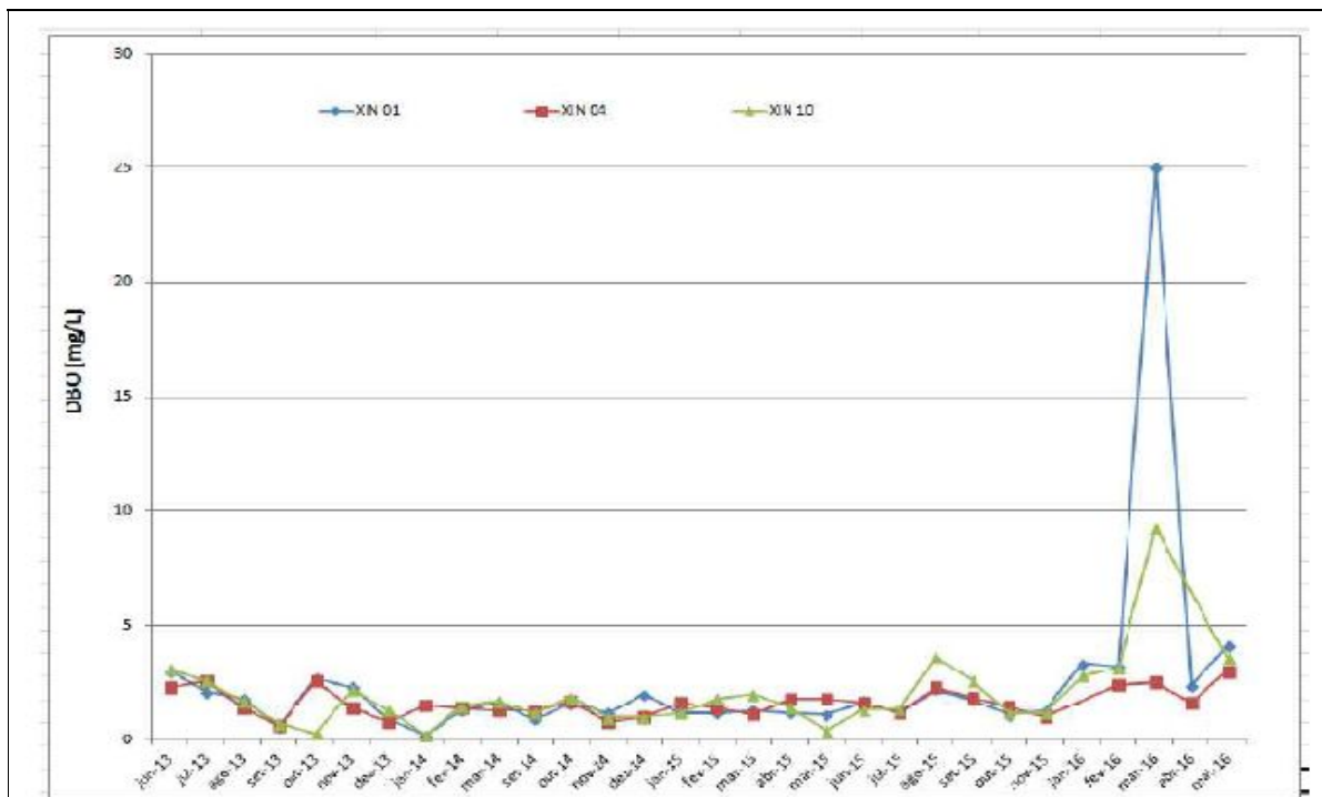
Figura 11: Concentração de DBO nas estações no reservatório da UHE Xingó. Fonte: Relatório Síntese para Flexibilização da Vazão Mínima de Restrição para 700 m 3 /s na Bacia do Rio São Francisco - Meio Ambiente, fl. 6.
