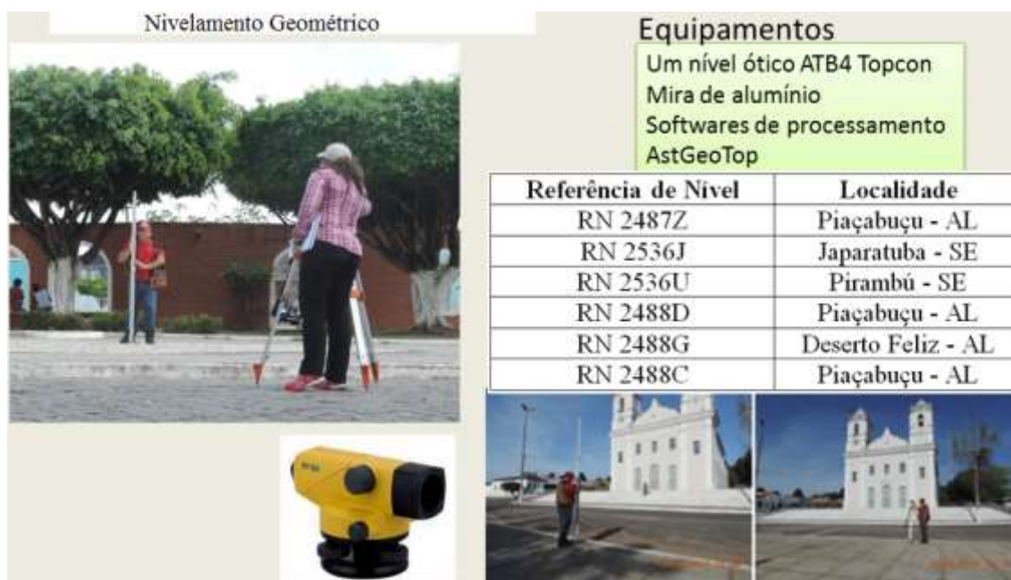
Figura 3: Equipamentos e acessórios utilizados para o transporte de altura utilizando o método do nivelamento geométrico, o procedimento em campo, as RRNN do IBGE identificadas em campo e observadas durante o levantamento de campo, além da igreja no município de Japarutuba-SE.
