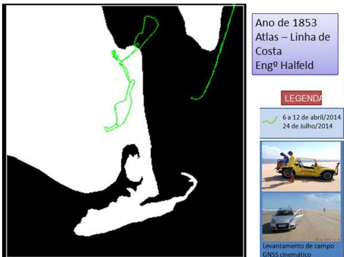
Figura 23: Linha de costa digitalizada da planta topográfica do Baixo da Foz do Rio São Francisco de 1853. As linhas verdes representam os levantamentos GNSS da linha de costa na margem direita da foz do Rio São Francisco realizado em abril de 2014 e na margem esquerda da foz realizado em julho de 2014.
