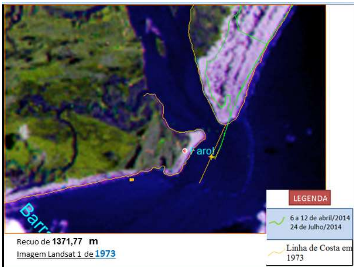
Figura 21: Imagem de satélite georreferenciada de 1973, o ponto mais ao sul levantado em abril de 2014, a localização do Farol no Povoado Cabeço, a linha utilizada como referência para a medição da distância e a linha de costa no Pontal do Atalaia na época da imagem, ano de 1973. As linhas verdes representam o percurso levantado com GNSS, ao longo da linha de costa na margem esquerda da foz do Rio São Francisco, em julho de 2014.
