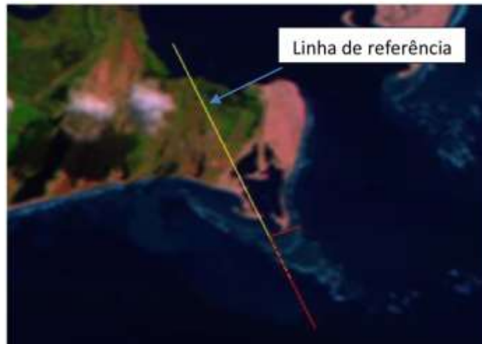
Figura 30.9 – Linha de referência para medir o deslocamento da linha de Costa.
