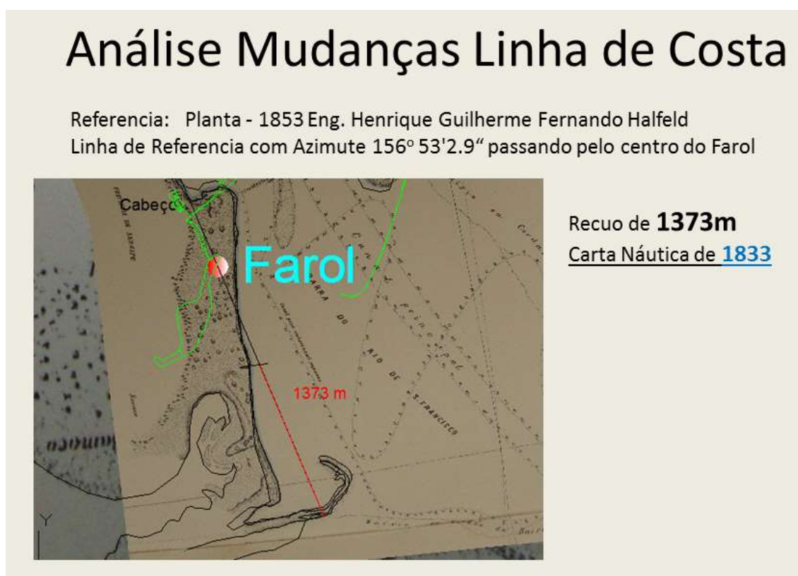
Figura 19: Planta da Barra do Rio São Francisco georreferenciada, ano de 1853, a localização do Farol no povoado Cabeço, a linha utilizada como referência para a medição da distância e a linha de costa traçada na Planta do Baixio da Foz do Rio São Francisco de 1853. As linhas verdes representam o levantamento com GNSS da linha de costa na margem direita da foz do Rio São Francisco, realizado em abril de 2014.
