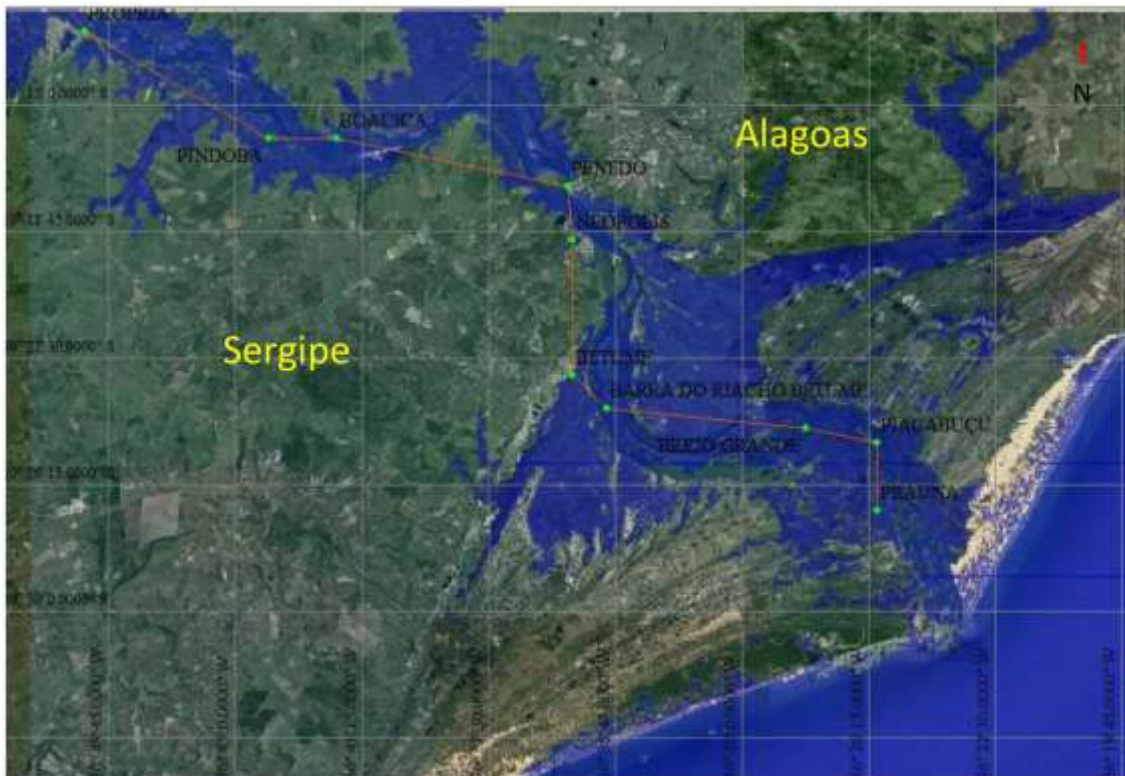
Figura 50.2 – Simulação usando o STRM da área de inundação, no período pós-barragens.
