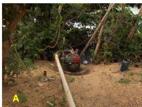
Figura 4.64 A e B Captação com bomba a óleo diesel (a esq.) e cultivo de maracujá (à dir.) na Ilha de Itapicuru
