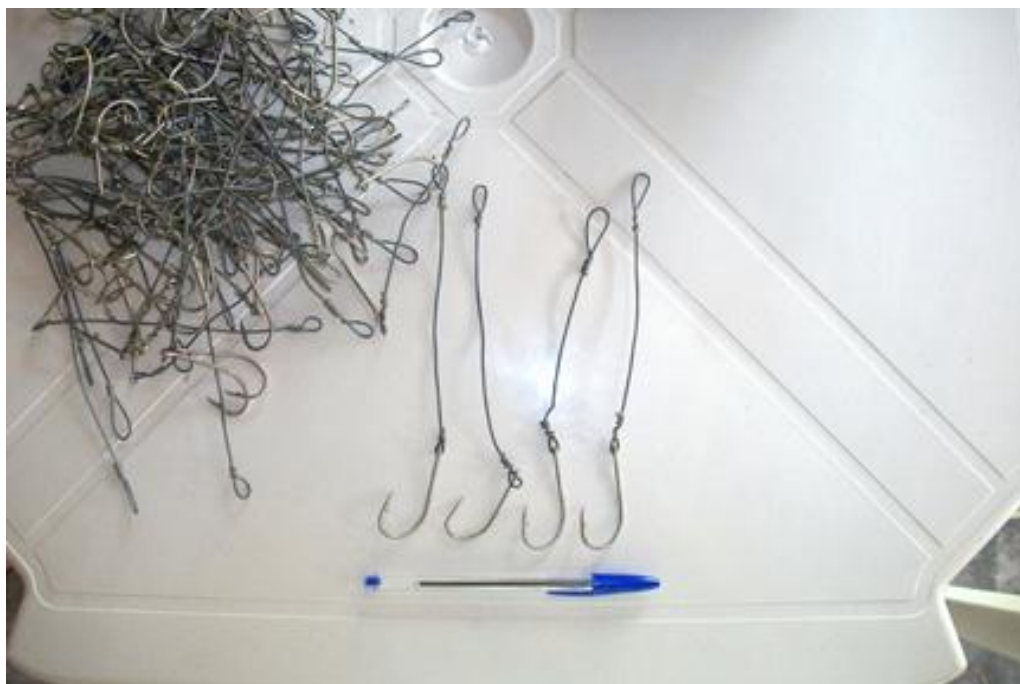
Figura 2.8.22 Montagem de anzóis empregados com linha - Fevereiro/2011
