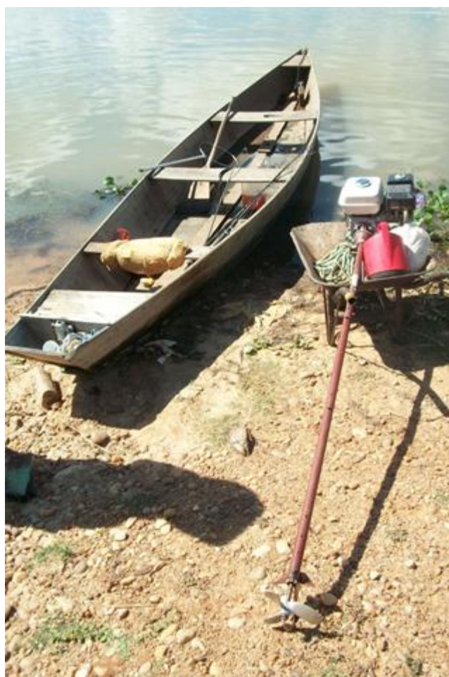
Figura 2.8.31 Canoa com motor de rabeta a gasolina - Fevereiro/2011
