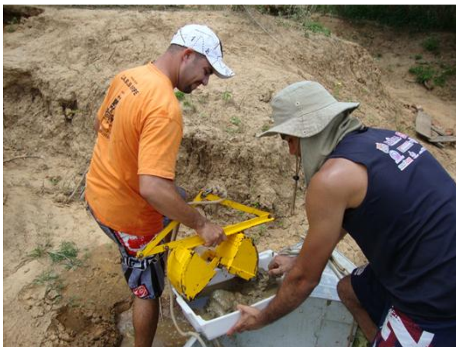
Figura 1.1.5 Recolhimento de amostra obtida com uma draga Petersen, em estação na margem de tributário - Janeiro/2011
