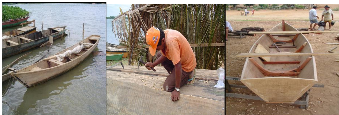
Figura 3.116 Embarcações de pesca artesanal e seu modo construtivo
