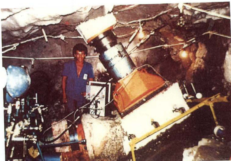
Figura 7 – Ensaio de cisalhamento in situ em galeria na fundação da barragem
