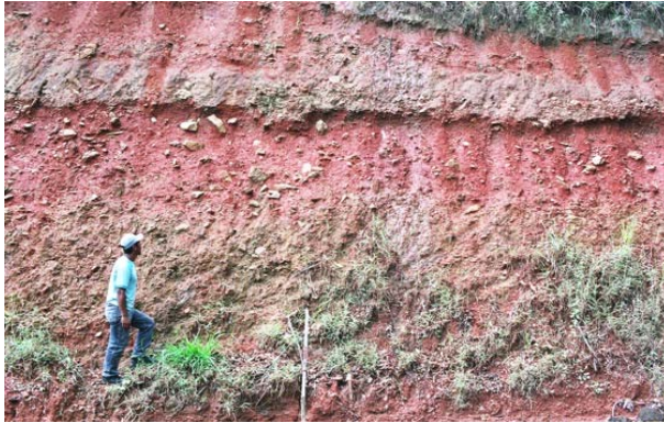
FOTO 53 - Ponto 30A UTM 703.048 mE x 7.268.525 mN - 237 m: Perspectiva das camadas do depósito rudáceo mostrando seqüências sedimentares distintas, com camada inferior rica em blocos arredondados grandes de quartzo e metapelito fresco, sendo que a camada superior contém fragmentos angulosos de quartzo esparsos, semelhante a depósito de tálus; a matriz é avermelhada, variegada de amarelo e branco, argilo-arenosa com grânulos e fragmentos de quartzo.
