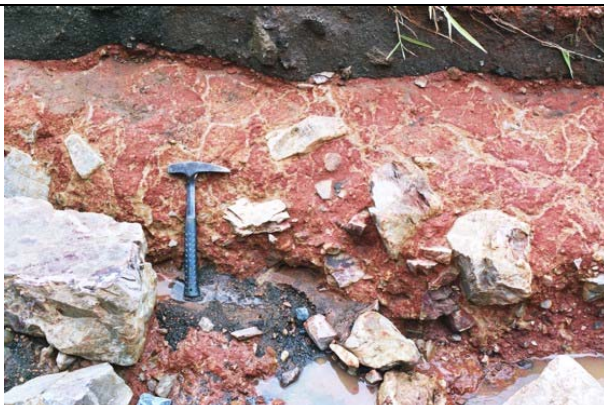
FOTO 54 - Ponto 30A UTM 703.048 mE x 7.268.525 mN - 237 m: pormenor da base do depósito rudáceo, ilustrado na foto 53, mostrando blocos de quartzo e metassedimentos imersos em matriz avermelhada e variegada, argilo arenosa, muito coesa, com grãos e fragmentos esparsos de quartzo.
