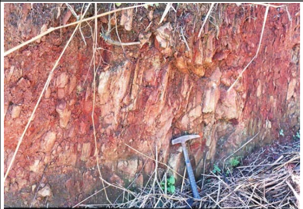
FOTO 79 - Ponto 31A UTM 703.384 mE x 7.268.802 mN – 242 m: plano de falha delimitando o flanco oposto do “horst” em relação ao ilustrado na foto 24. A falha põe em contato metapelitos alterados com depósitos rudáceos que ocupam toda a metade direita da foto
