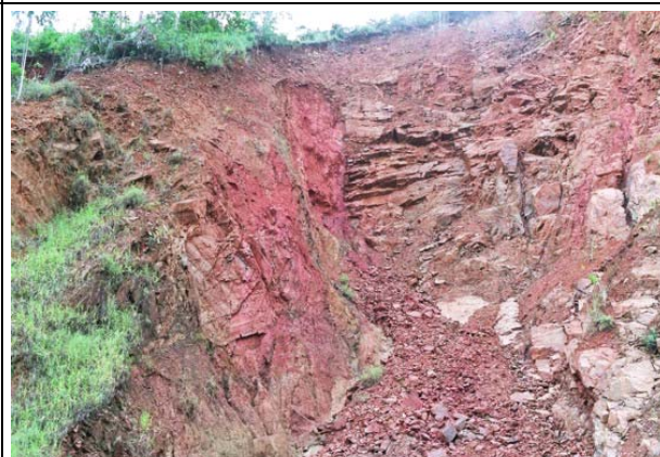
FOTO 67 - Ponto 29A UTM 702.904 mE x 7.268.177 mN – 263 m: aspecto de grande escorregamento em encosta de metapelitos alterados, cortado por dique máfico ilustrado na foto 23.
