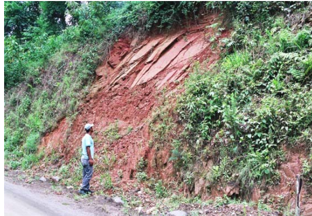
FOTO 23 - Ponto 29A UTM 702.904 mE x 7.268.177 mN - 263 m: delgado dique máfico intemperizado, cortando metapelitos alterados na direção N60°E; 77°NW; a foliação dos metapelitos tem orientação N70°E; 55°NW.
