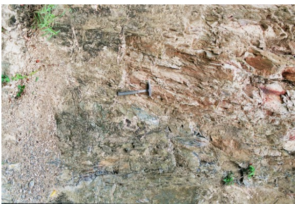
FOTO 38 - Ponto 6A UTM 712.976 mE x 7.283.875 mN – 696 m: metapelitos em contato de falha com granito porfiróide; a foliação tem direção N90°; 60°N (direção do falhamento).
