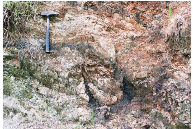
FOTO 39 - ponto 30 UTM 687.950 mE x 7.264.613 mN - 473 m: calcário com nítida foliação na direção N15°; 40°SE; o afloramento é capeado por solo residual argiloso vermelho, que ocorre também interpenetrado nos planos de foliação; a rocha é um mármore fino, cinza claro.
