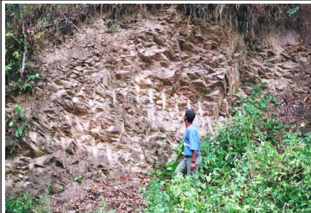
FOTO 18 - Ponto 22 UTM 686.582 mE x 7.260.880 mN - 651 m: metapelito alterado, sem mica, siltítico, com acamamento na direção N25°, mergulhando de 55° a 70° para SE.
