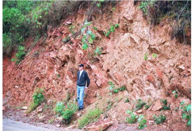
FOTO 39 - ponto 30 UTM 687.950 mE x 7.264.613 mN - 473 m: calcário com nítida foliação na direção N15°; 40°SE; o afloramento é capeado por solo residual argiloso vermelho, que ocorre também interpenetrado nos planos de foliação; a rocha é um mármore fino, cinza claro.
