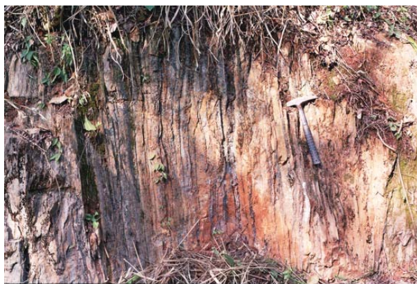
FOTO 30 - Ponto 1A UTM 716.287 mE x 7.285.712 mN - 893 m: rocha carbonática xistosa com foliação na direção N65°W; 45°SW; tem coloração cinzenta e torna-se esbranquiçada quando alterada.
