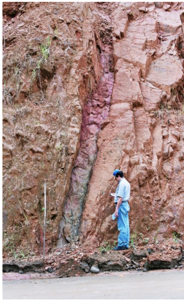
FOTO 25 - Ponto 54A UTM 678.027 mE x 7.251.557 mN - 446 m: filito sericítico rosado na estrada entre Cerro Azul e Tunas do Paraná; quando são, apresentam coloração cinzenta prateada; a foliação tem orientação N25°E; 70°NW.
