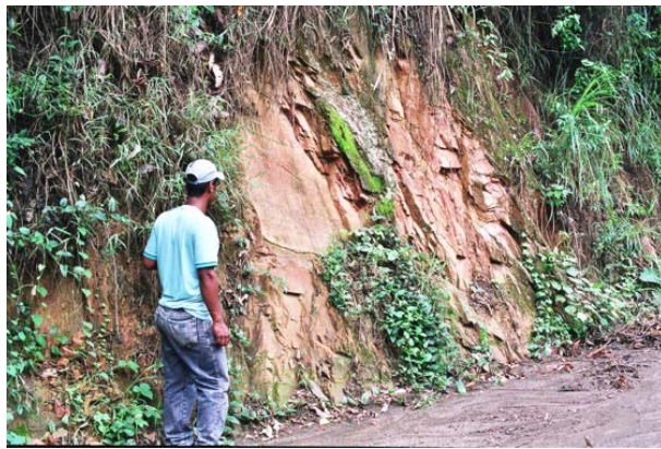
FOTO 19 - Ponto 22A UTM 701.361 mE x 7.266.354 mN - 387 m: metapelito rítmico, pouco micáceo, com acamamento na direção N35°E; 30°NW.
