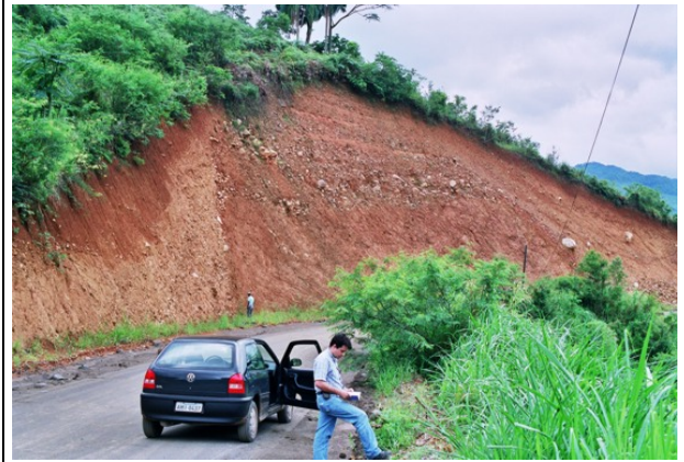
FOTO 25 - Ponto 54A UTM 678.027 mE x 7.251.557 mN - 446 m: filito sericítico rosado na estrada entre Cerro Azul e Tunas do Paraná; quando são, apresentam coloração cinzenta prateada; a foliação tem orientação N25°E; 70°NW.
