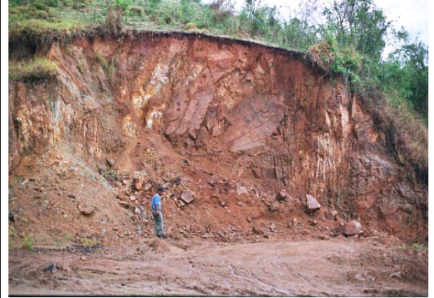
FOTO 7 - Ponto 100: UTM 686.254 mE x 7.280.422 mN -624m: vista seqüencial de grande saibreira em granito porfiróide saprolitizado, entrecortado por numerosos veios pegmatóides e aplíticos, que mergulham para a esquerda da seqüência fotográfica; local próximo a Itapirapuã.
