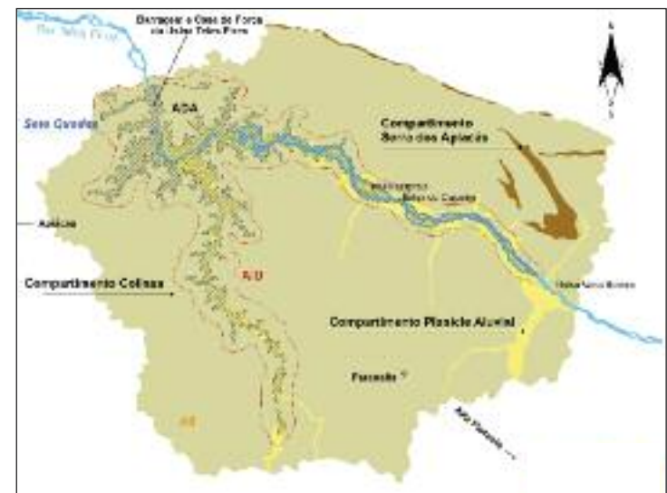
Área de Influência Direta (AID) - 1 km de largura ao longo do rio. Área de Influência Indireta (AII) - área de drenagem do futuro reservatório. Área Diretamente Afetada (ADA) - área da barragem, do reservatório e área de preservação permanente (APP).
