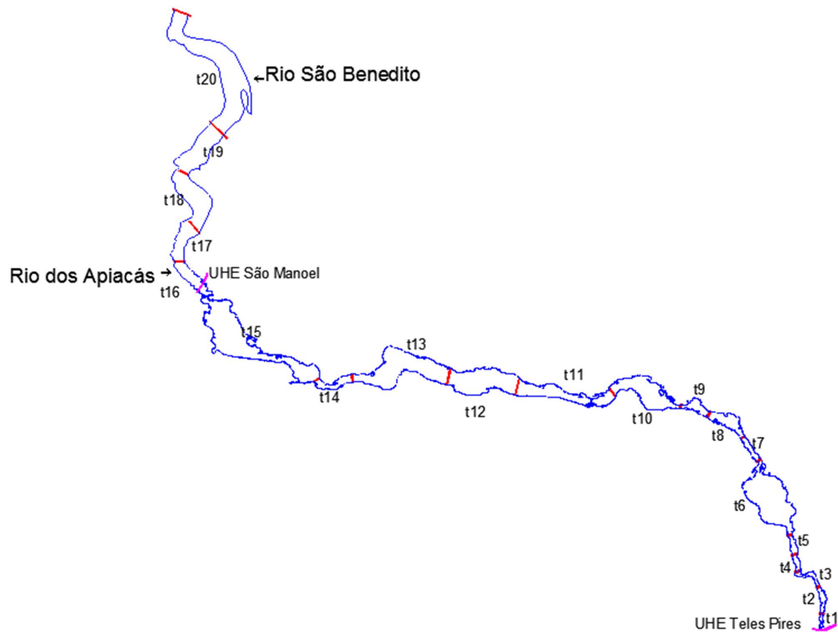
FIGURA 5.6 Divisão dos trechos do estirão de jusante da UHE Teles Pires.
