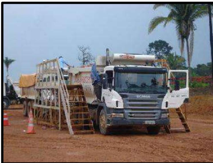
**Escada e passarela para acoplamento de lona a fim de evitar ação do vento sobre material solto nos caminhões que trafegam no acesso interno do canteiro**
