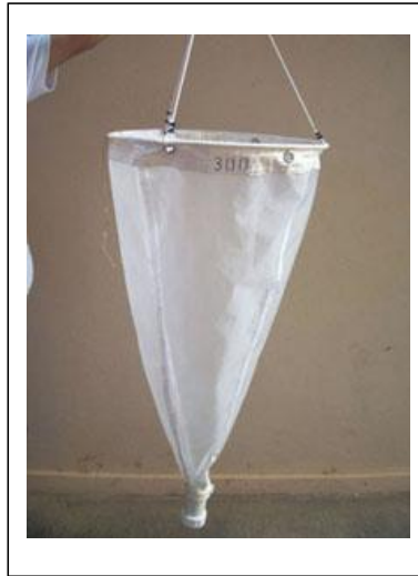
Figura 2- Rede de coleta para ictioplâncton
