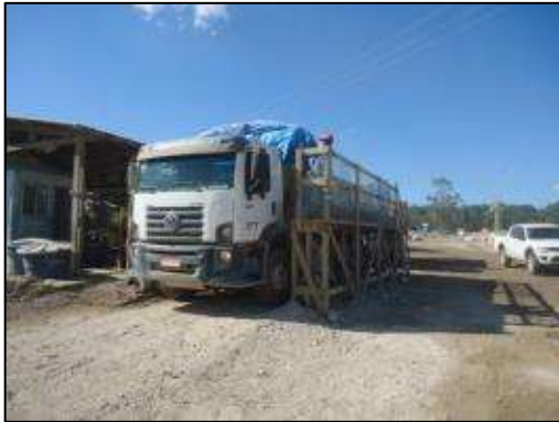
Escada e passarela para acoplamento de lona a fim de evitar ação do vento sobre material solto nos caminhões que trafegam no acesso interno do canteiro
