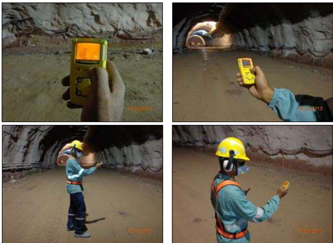
Monitoramento de gases tóxicos – Túneis emboque e desemboque.
