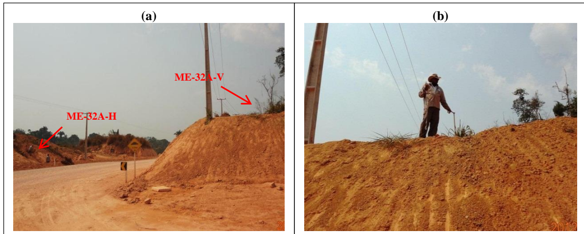
Figura 1. Instalação das estacas de monitoramento na campanha de setembro de 2012: (a) localização das duas estacas inseridas; (b) localização da estaca ME-32A-V.
