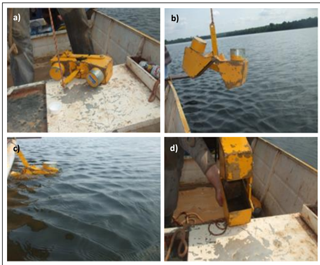
Figura 15. Amostragem do sedimento de leito utilizando a Draga de Petersen (a), (b), (c) e (d).
