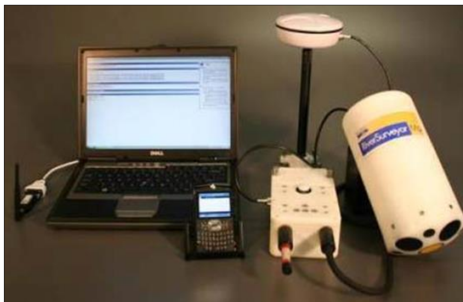
Figura 11. Hardware montado para a opção D-GPS com comunicações Bluetooth.
