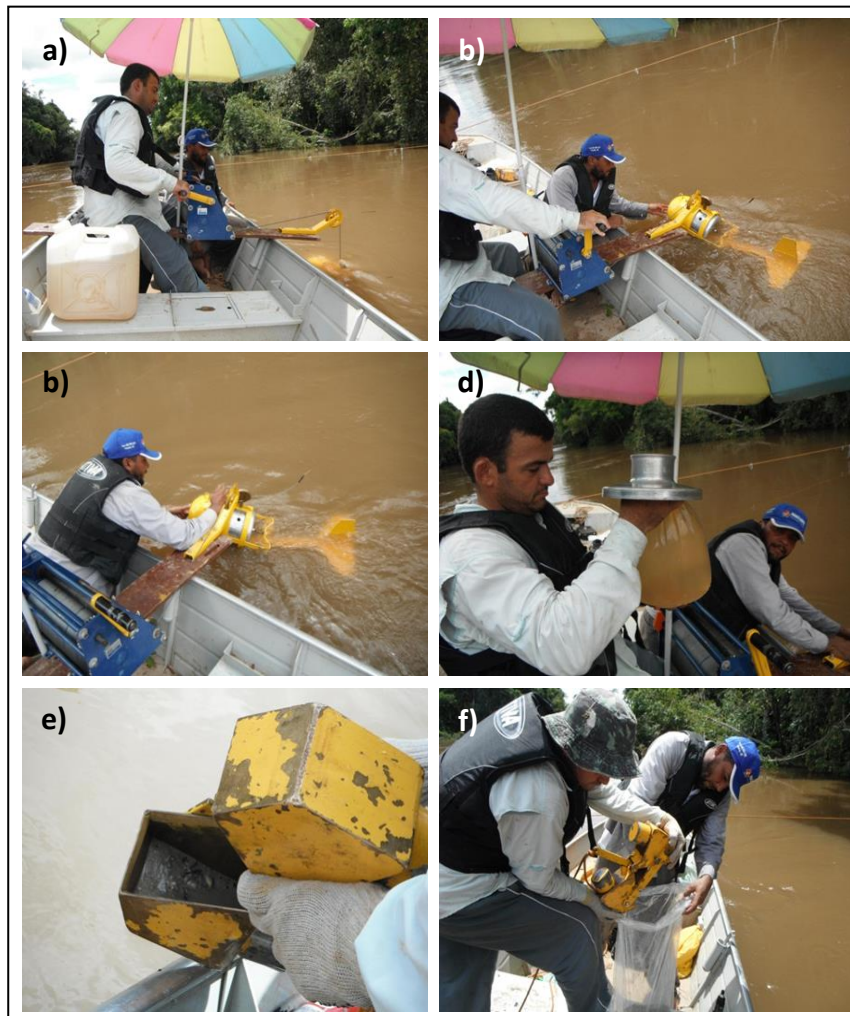
Figura 13. Amostragem da mistura água-sedimento utilizando o amostrador Saca AMS-8 (a, b, c, d) e amostragem do material de leito com a Draga Petersen (e, f).
