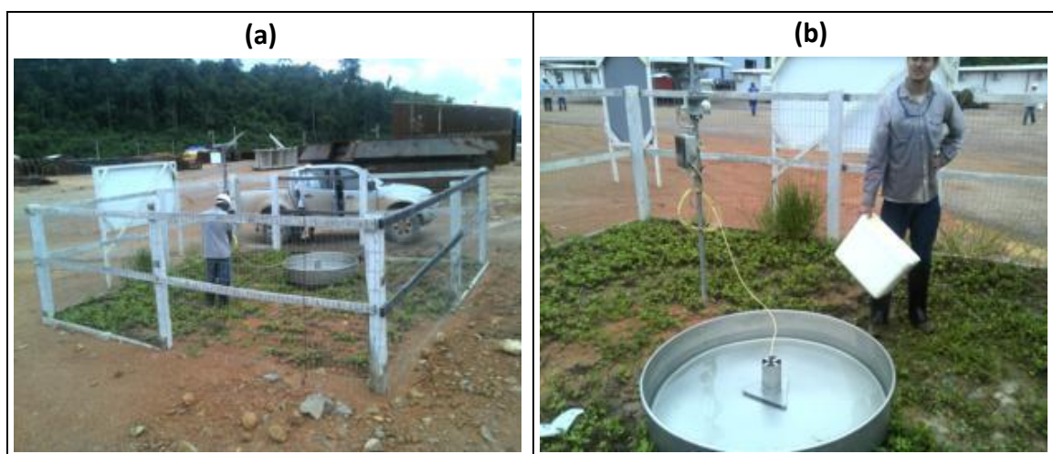
Figura 14. Manutenção da estação meteorológica UHE Teles Pires. (a) Visão geral da estação; e (b) Limpeza do tanque de evaporação (tanque classe A).
