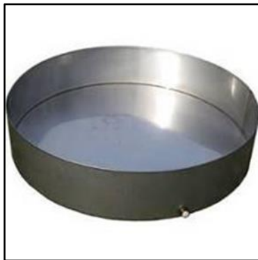
Figura 24. Painel (tanque) de evaporação Classe A.
