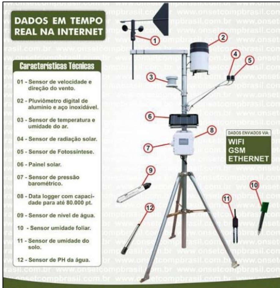
Figura 17. Estação Meteorológica automática Onset, com transmissão de dados por satélite.
