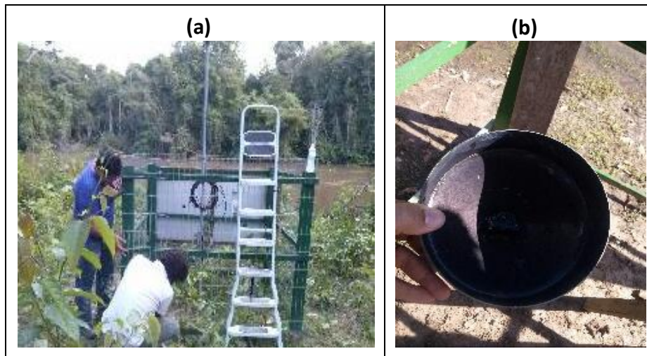
Figura 13. Manutenção das estações pluviométricas da UHE Teles Pires durante o mês de janeiro de 2014. (a) Profissional realizando a manutenção da estação pluviométrica; e (b) Visão do pluviômetro aberto para limpeza.
