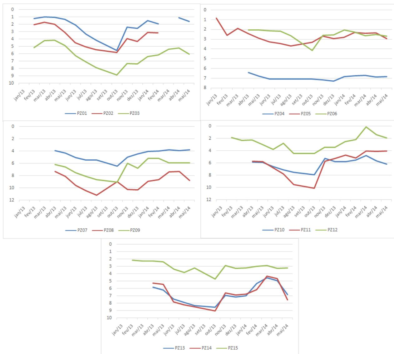
Figura 33. Tendência dos níveis nos piezômetros localizados na UHE Teles Pires.
