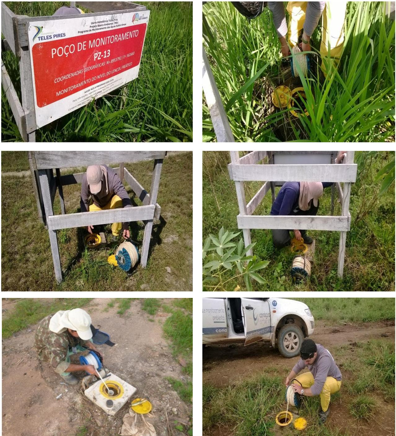
**Figura 6.** Registro das leituras de nível realizadas nos piezômetros monitorados na UHE Teles Pires.
