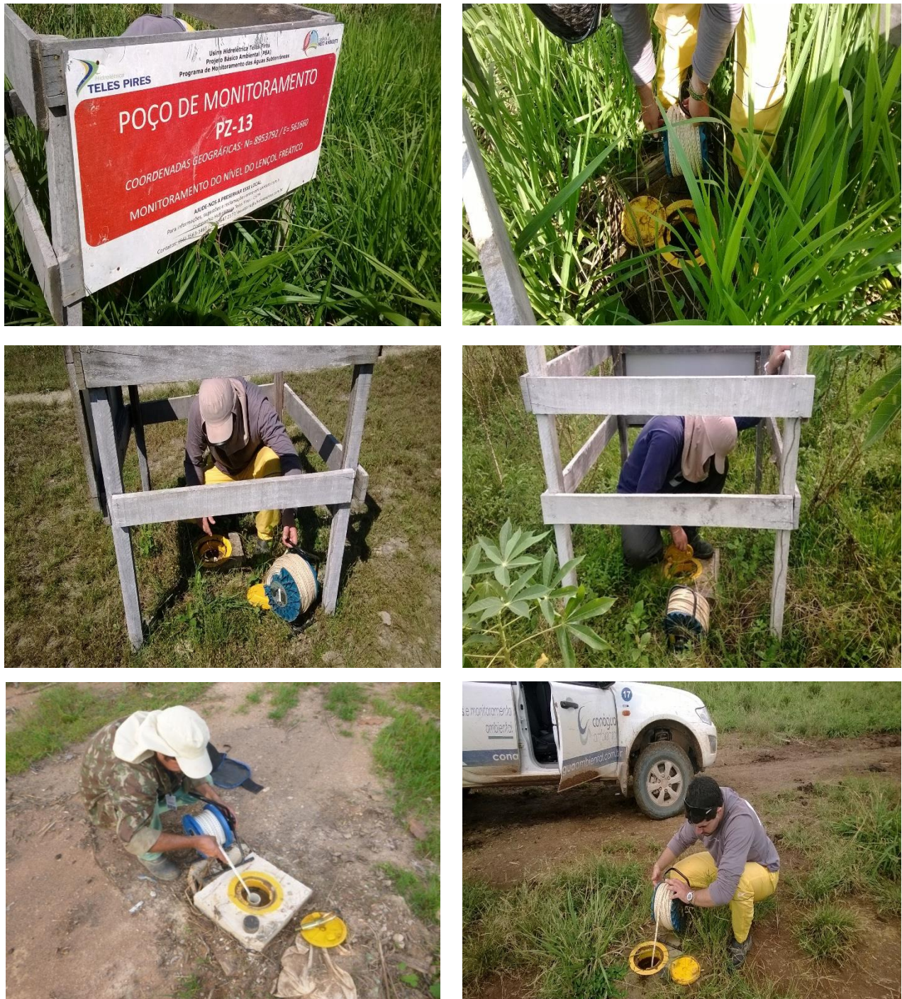
Figura 13 – Registro das leituras de nível realizadas nos piezômetros monitorados na UHE Teles Pires.
