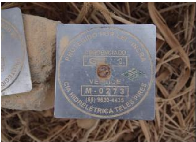
Marco com plaqueta de identificação de vértices - Normas Técnicas do INCRA
