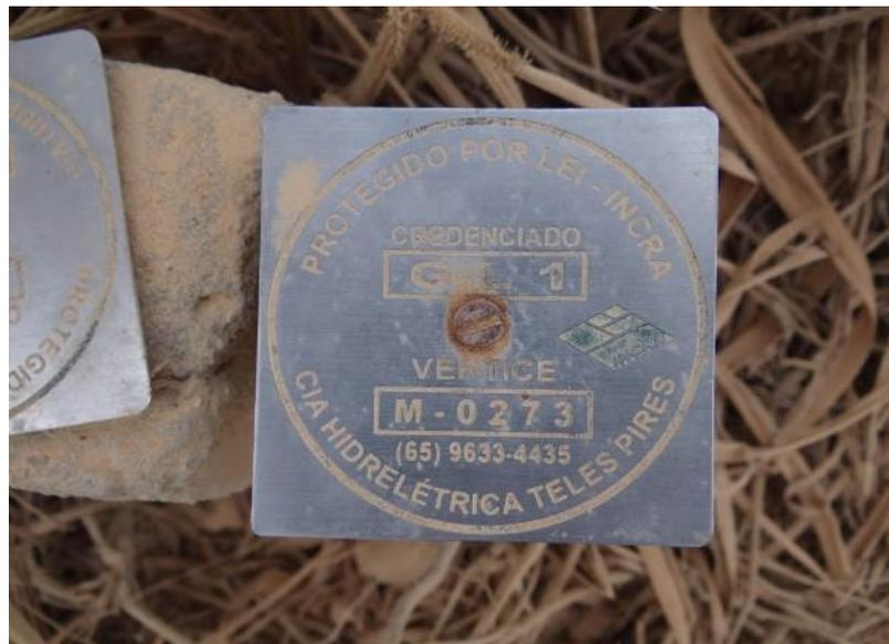
**Figura 2 - Marco de ferro galvanizado com plaqueta de identificação de vértices de acordo com as Normas Técnicas do INCRA**
