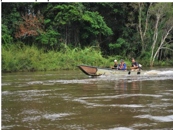
Figura 83. Embarcação de madeira propulsionada por motor rabeta.
