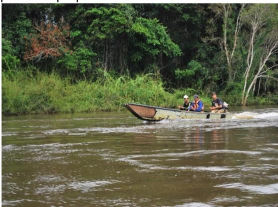
Figura 83. Embarcação de madeira propulsionada por motor rabeta.
