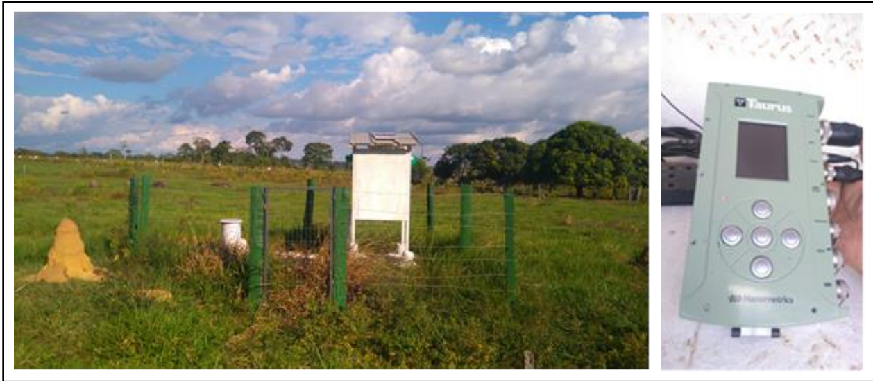
Figura 2. Manutenção da estação sismográfica STP1 realizada no mês de julho de 2016.
