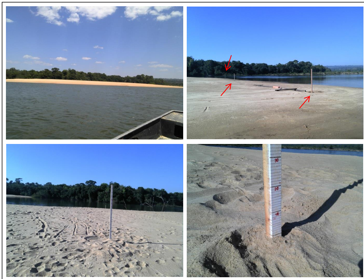
Figura 30. Instalação das estacas graduadas na praia P2 (21 L 493851 8990172) realizada no dia 19 de agosto de 2014. As setas em vermelho indicam as posições das estacas.
