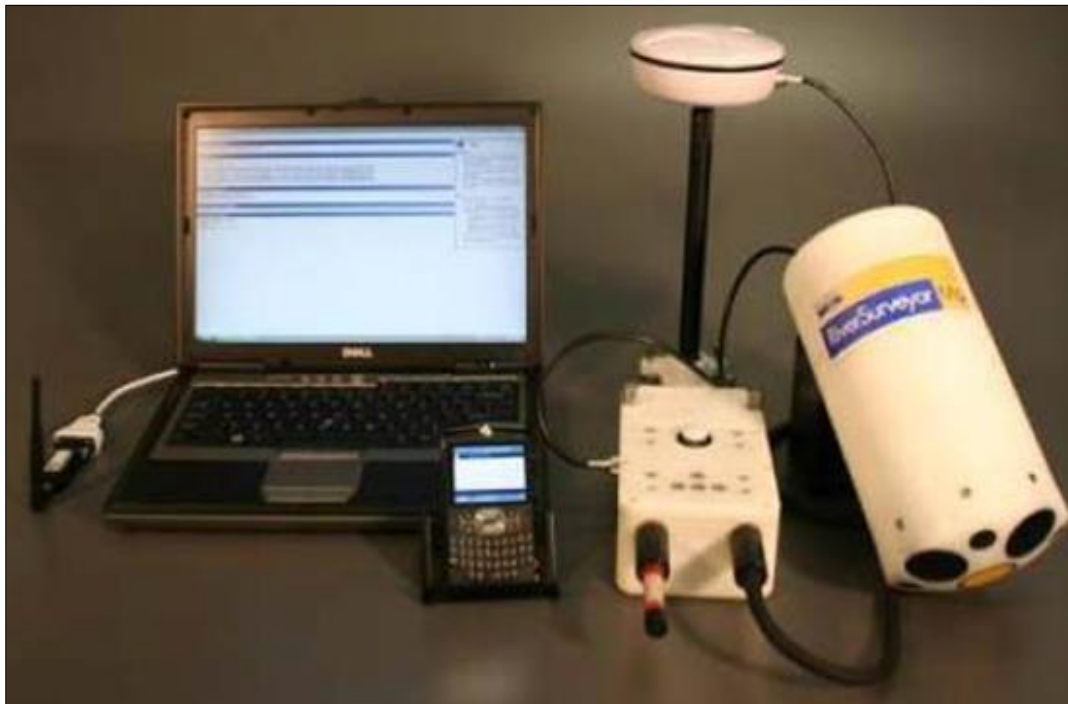
Figura 12. Hardware montado para a opção D-GPS com comunicações Bluetooth .
