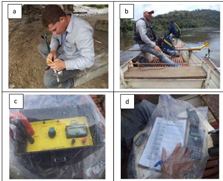
Figura 9. (a) Montagem e preparação do molinete hidrométrico; (b) molinete hidrométrico completo pronto para utilização; (c) contador de impulsos envolvido em plástico impermeável contra chuva; (d) planilhas de anotações hidrométricas com saco plástico contra chuva.
