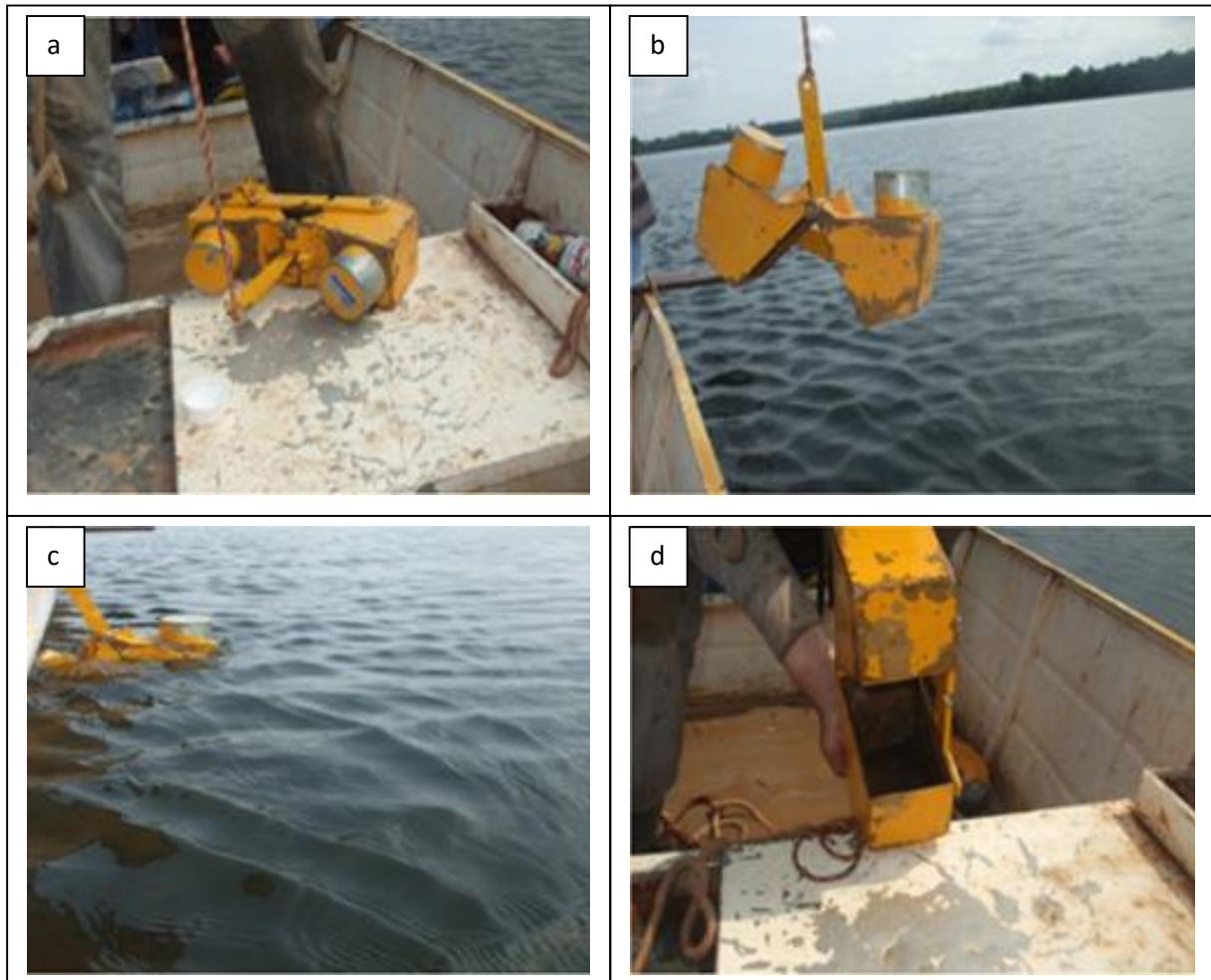
Figura 16. Amostragem do sedimento de leito utilizando a Draga de Petersen (a, b, c e d).
