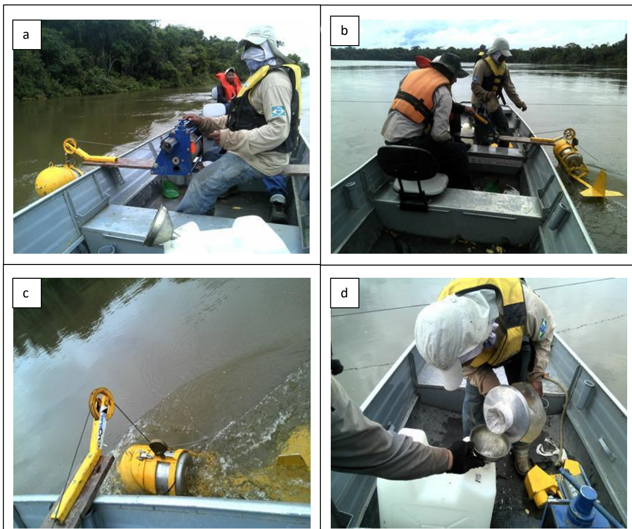
Figura 14. Amostragem da mistura água-sedimento utilizando o amostrador Saca AMS-8 (a, b, c e d).
