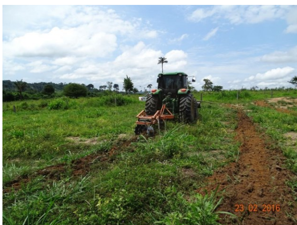
Foto 107. Preparo de solo/Marcação de Linhas de plantio com subsolador florestal.
