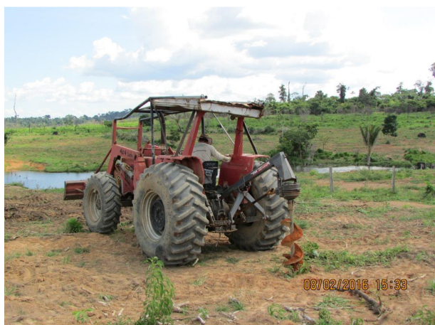
Foto 05. Perfuração mecanizada para construção das cercas.
