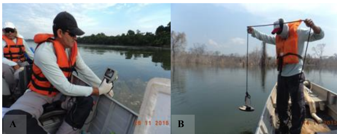
Figura 6. Obtenção de dados ambientais. A: Medição de temperatura e oxigênio; B: Medição da transparência com o disco de Secchi.
