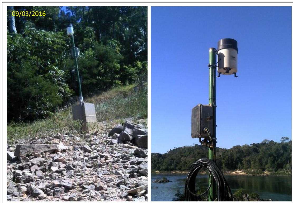
Figura 22. Estação hidrométrica UHE Teles Pires Jusante instalada nas coordenadas Latitude 09°19'51.0"/longitude -56°46'40.0", no dia 09 de março de 2016.
