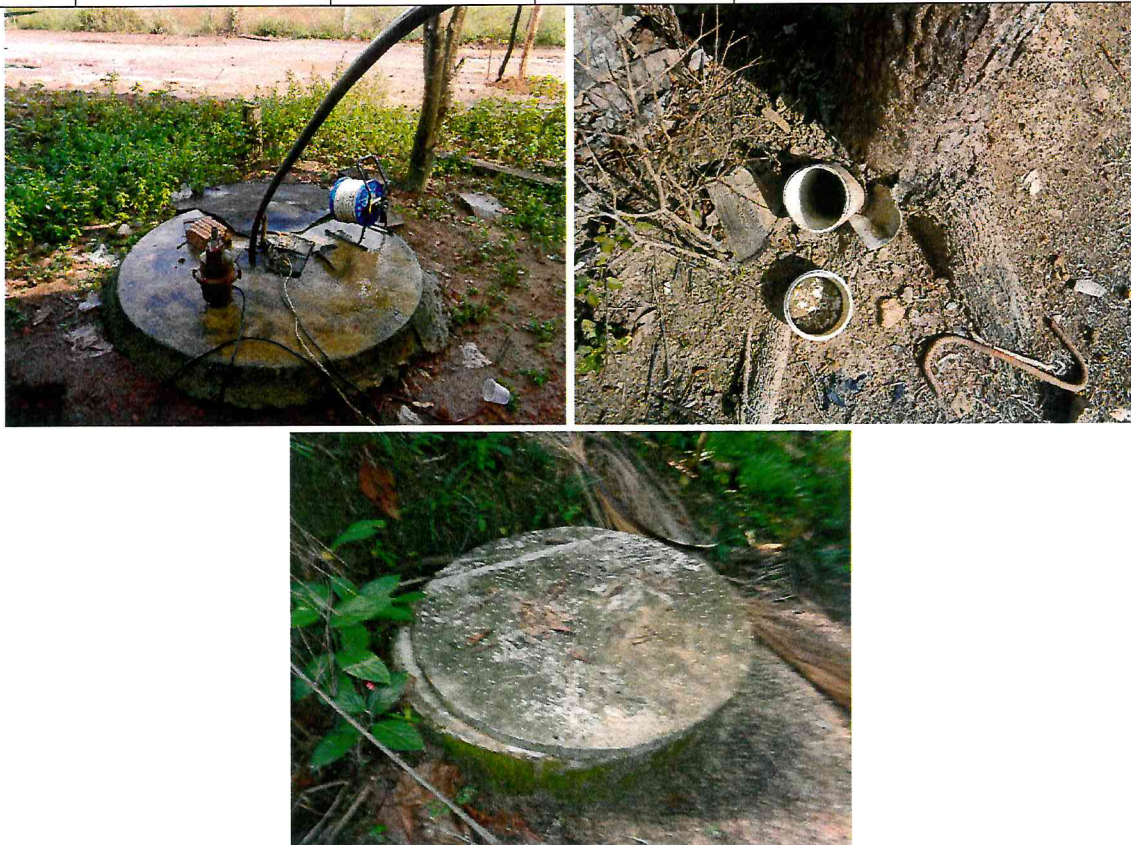
Figura 1. Pontos para monitoramento da qualidade da água sem necessidade de sondagem devido à utilização de poços existentes (PM01, PM03, PM04) na área de influência da UHE Teles Pires.
