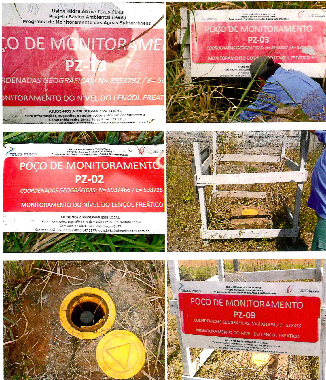
Figura 2. Pontos de amostragem dos Piezômetro na área de influência da UHE Teles Pires.
