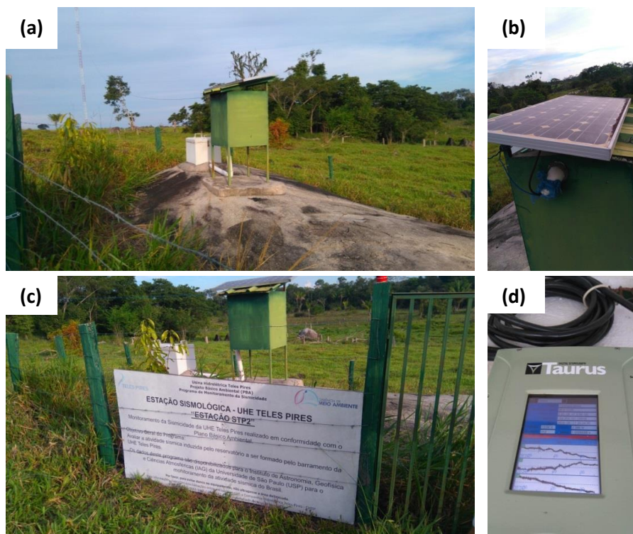
Figura 3. Manutenção da estação sismográfica STP2; (a) Visão externa da estação STP2; (b) Imagem do painel solar da estação; (c) Imagem da placa de identificação da estação sismográfica; e (d) Datalogger da estação em funcionamento durante a atividade de manutenção.
