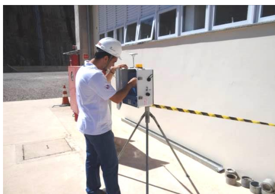
Figura 04. Monitoramento de material particulado na área externa da Casa de Força.
