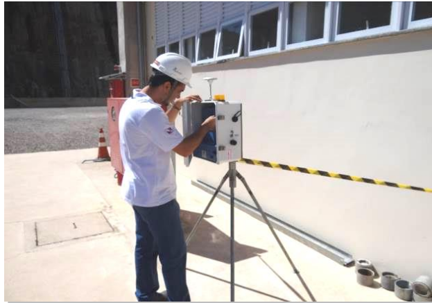
Figura 03. Monitoramento de material particulado na área externa da Casa de Força.
