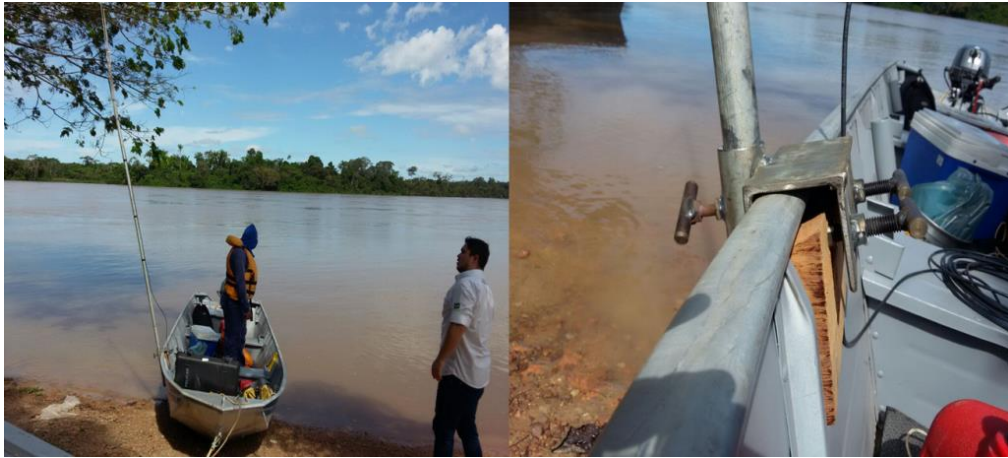
Figura: Fixação de antena em embarcação para rastreamentos móveis no rio Teles Pires.
