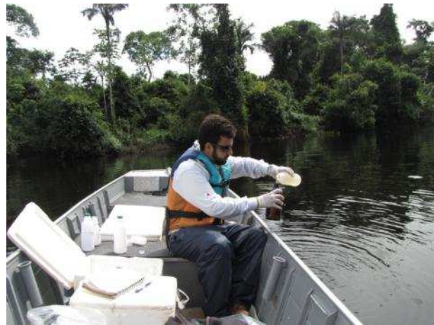
Figura 48. Coleta de água durante as atividades de monitoramento da ictiofauna e limnológico e qualidade da água – PBAI – P45 no ponto de amostragens P04, rio Cururu, janeiro de 2015.
