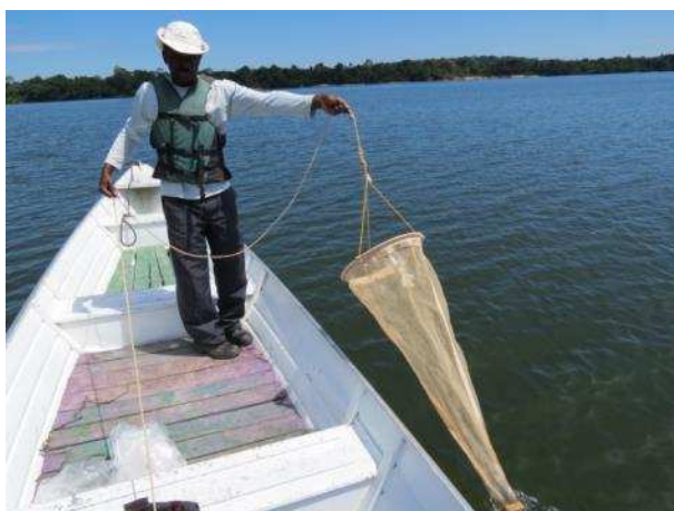
Figura 33. Procedimento de coleta de ovos e larvas de ictiofauna com rede de zooplâncton, no ponto de amostragens P08, rio Teles Pires, julho de 2015.
