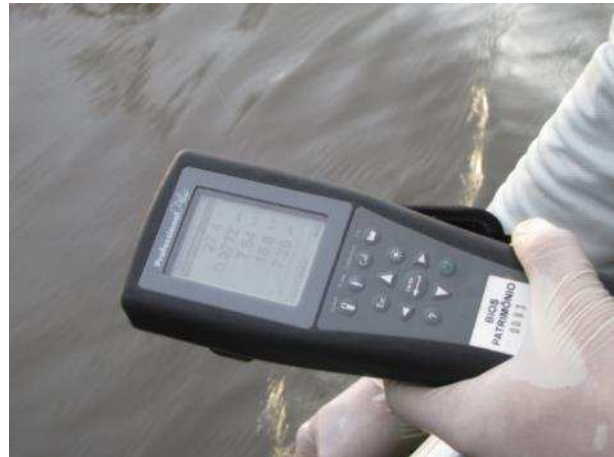
Figura 46. Detalhe da coleta de informações com sonda multi-parâmetros, durante as atividades de monitoramento da ictiofauna e limnológico e qualidade da água – PBAI – P45, abril de 2014.
