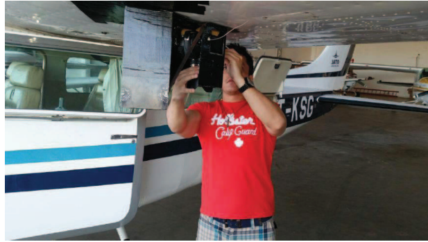
Preparação do equipamento aerofotogramétrico para o sobrevoo.
