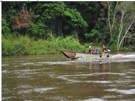
Figura 83. Embarcação de madeira propulsionada por motor rabeta.
