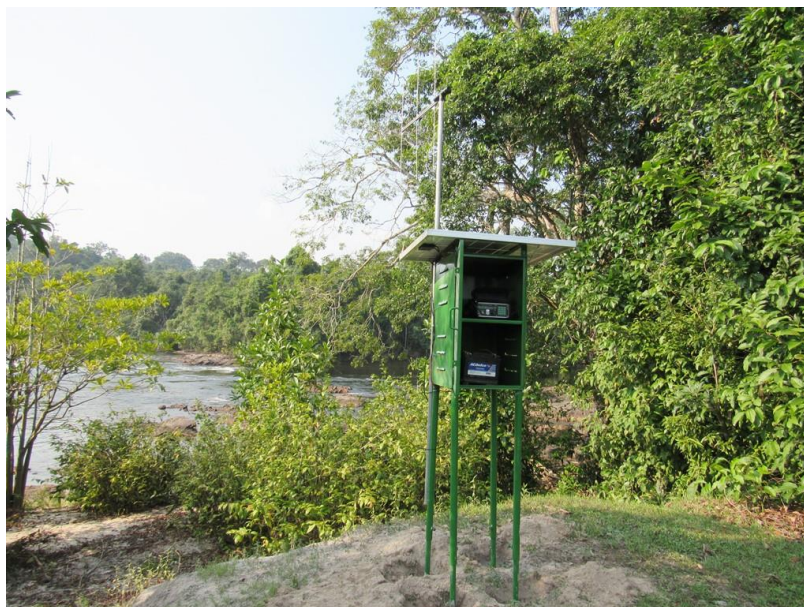
Figura 5 – Base fixa de radiotelemetria instalada na RPPN do Cristalino.
