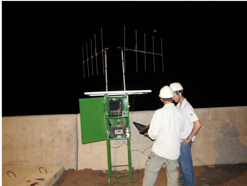
Figura 4 – Configuração da base de radiotelemetria instalada na UHE Teles Pires.
